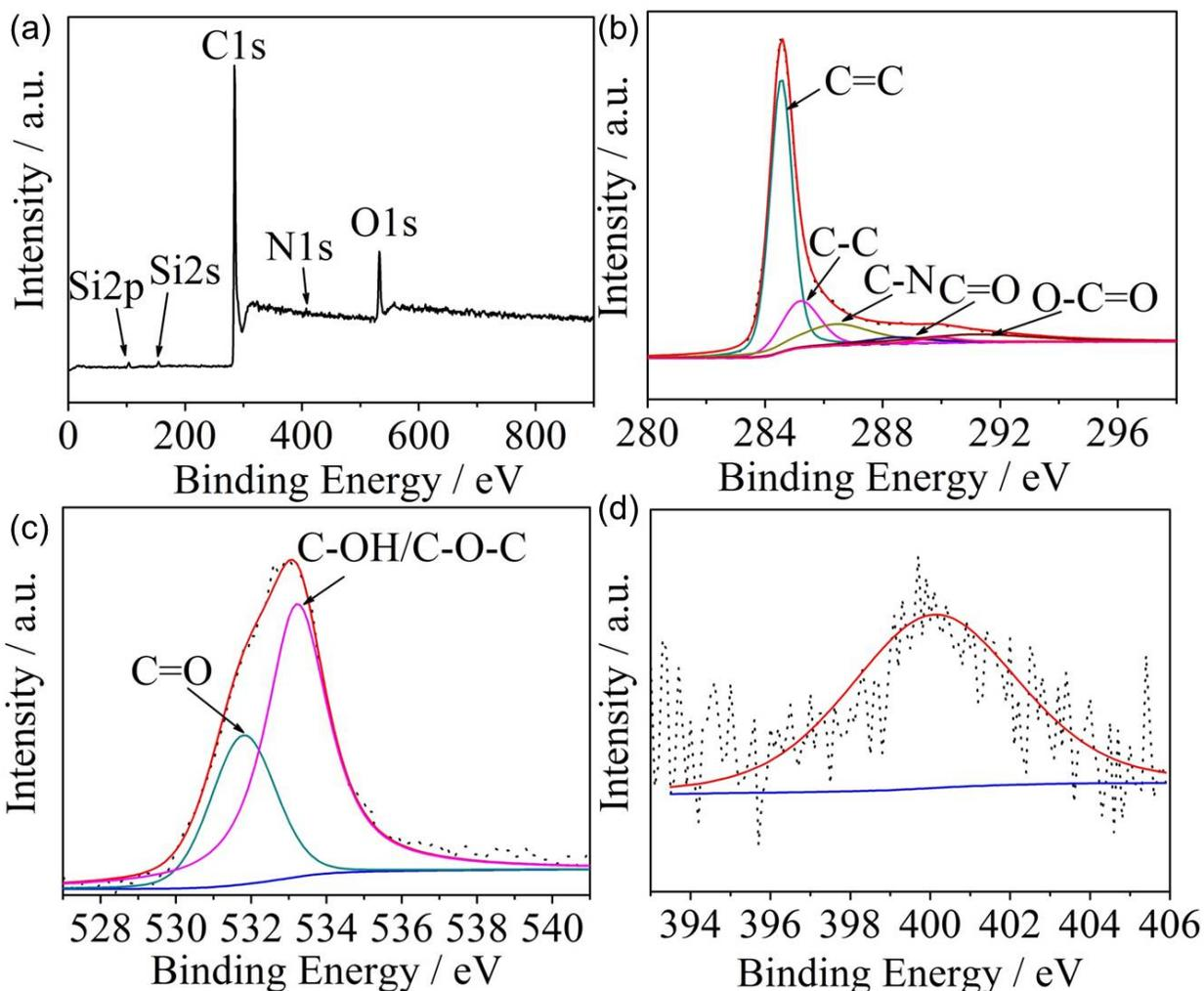
Fig. S13 (a) XPS, (b) C 1s, (c) O 1s, (d) N 1s of  $C_{bam-LE}$ .
