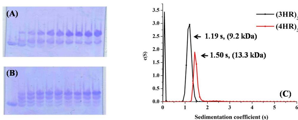
**Fig. S4.** (A) SDS-PAGE analysis of 4HR(SBn) at 0 h (lane 1), 2 h (lane 2), 4 h (lane 3), 6 h (lane 4), 8 h (lane 5), 12 h (lane 6), 14 h (lane 7), 16 h (lane 8), 18 h (lane 9), and 20 h (lane 10). (B) SDS-PAGE analysis of 3HR(SBn) at 0 h (lane 1), 4 h (lane 2), 8 h (lane 3), 12 h (lane 4), 16 h (lane 5), 20 h (lane 6), 24 h (lane 7), 28 h (lane 8), 36 h (lane 9) and 40 h (lane 10). (C) SVA of crosslinked (4HR)<sub>3</sub> and (3HR)<sub>3</sub> trimers.
