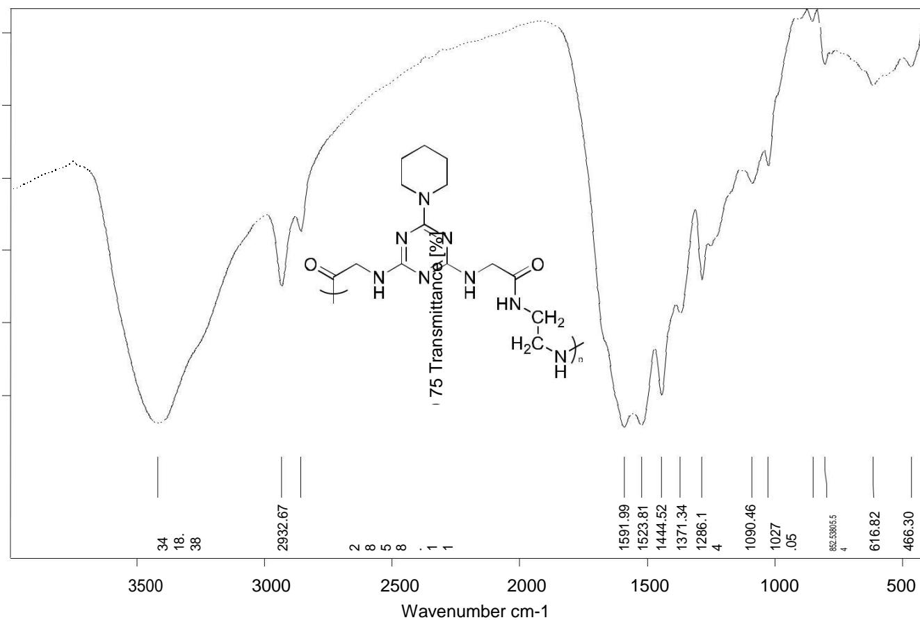
**Figure 28:** IR (KBr) of poly[2-(4-(2-(2-aminoethylamino)-2-oxoethylamino)-6-(piperidin-1-yl)-1,3,5-triazin-2-ylamino)acetic acid] 27.
