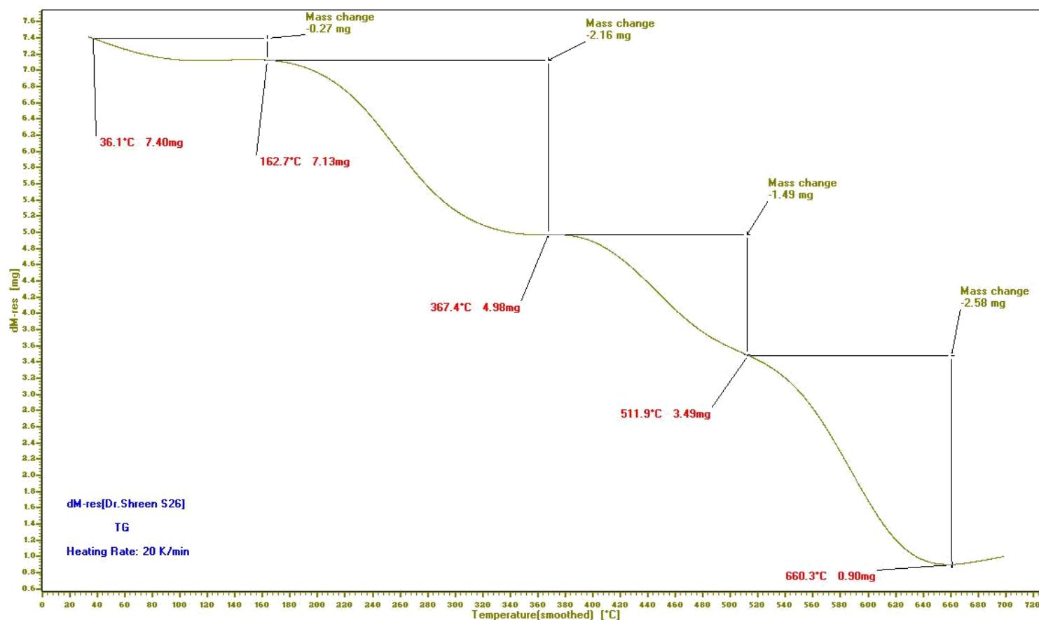
**Figure 124:** TGA of poly[2-(4-(2-(4-aminophenylamino)-2-oxoethylthio)-6-(piperidin-1-yl)-1,3,5-triazin-2-ylthio)acetic acid] **46.**
