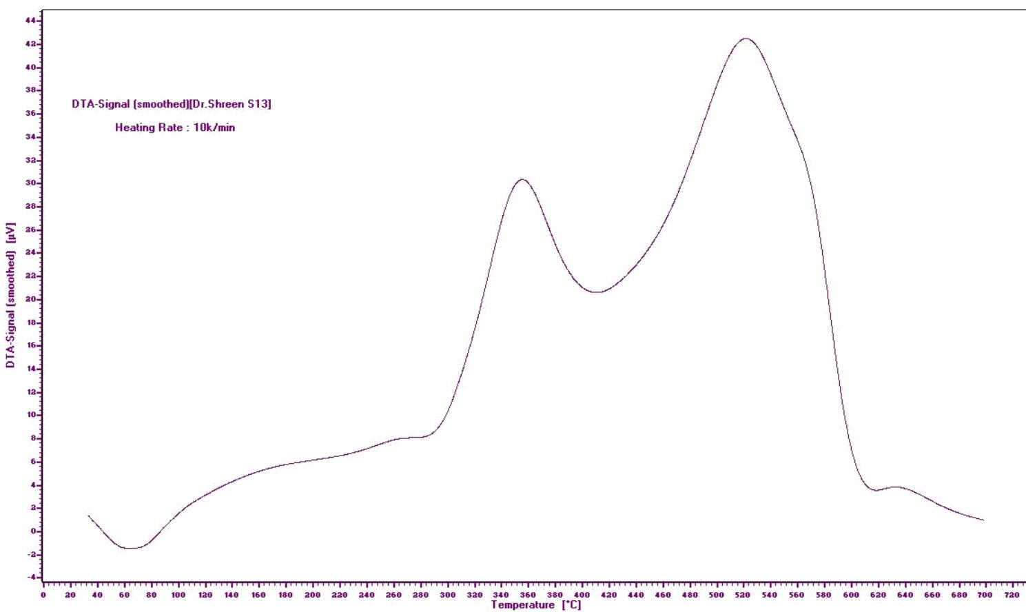
**Figure 116:** DTA of poly[2-(4-(2-(2-aminoethylamino)-2-oxoethylthio)-6-morpholino-1,3,5-triazin-2-ylthio)acetic acid] **44.**
