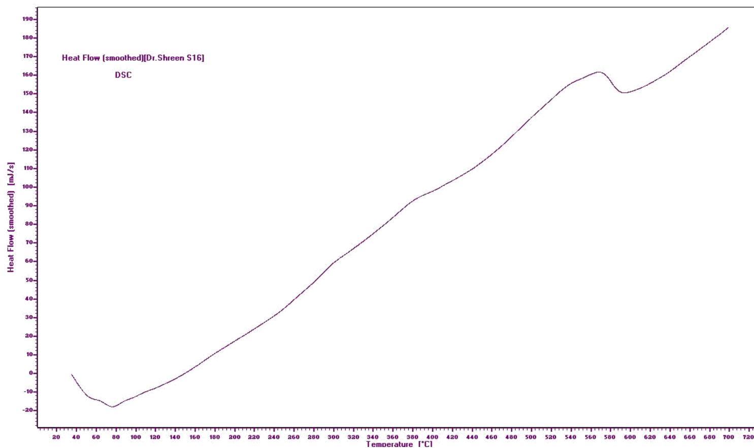
**Figure 47:** DSC of poly[2-(4-(2-(2-aminoethylamino)-2-oxoethylthio)-6-(phenylamino)-1,3,5-triazin-2-ylthio)acetic acid] **30**.
