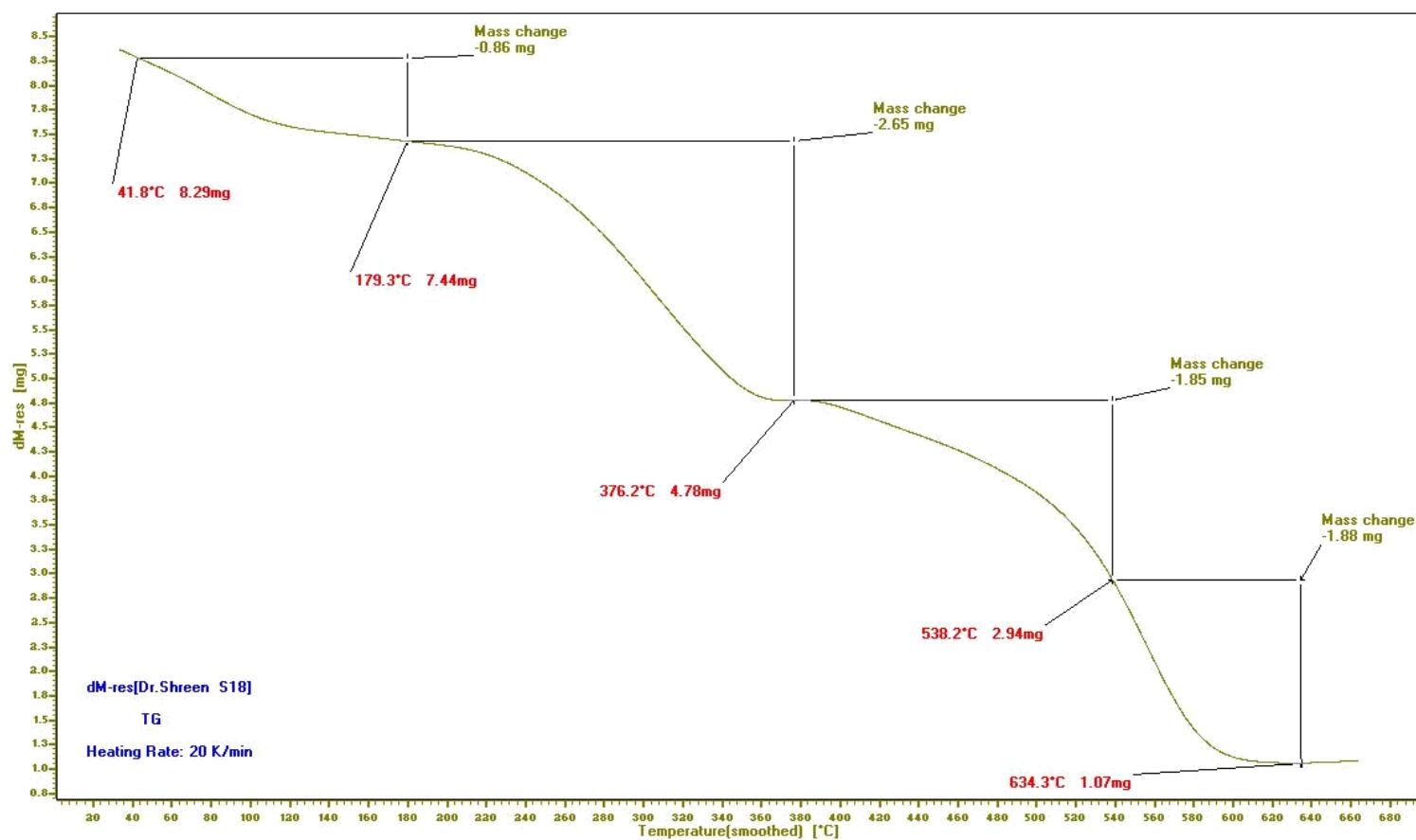
**Figure 39:** TGA of poly[2-(4-(2-(2-aminoethylamino)-2-oxoethylamino)-6-(phenylamino)-1,3,5-triazin-2-ylamino)acetic acid] 29.
