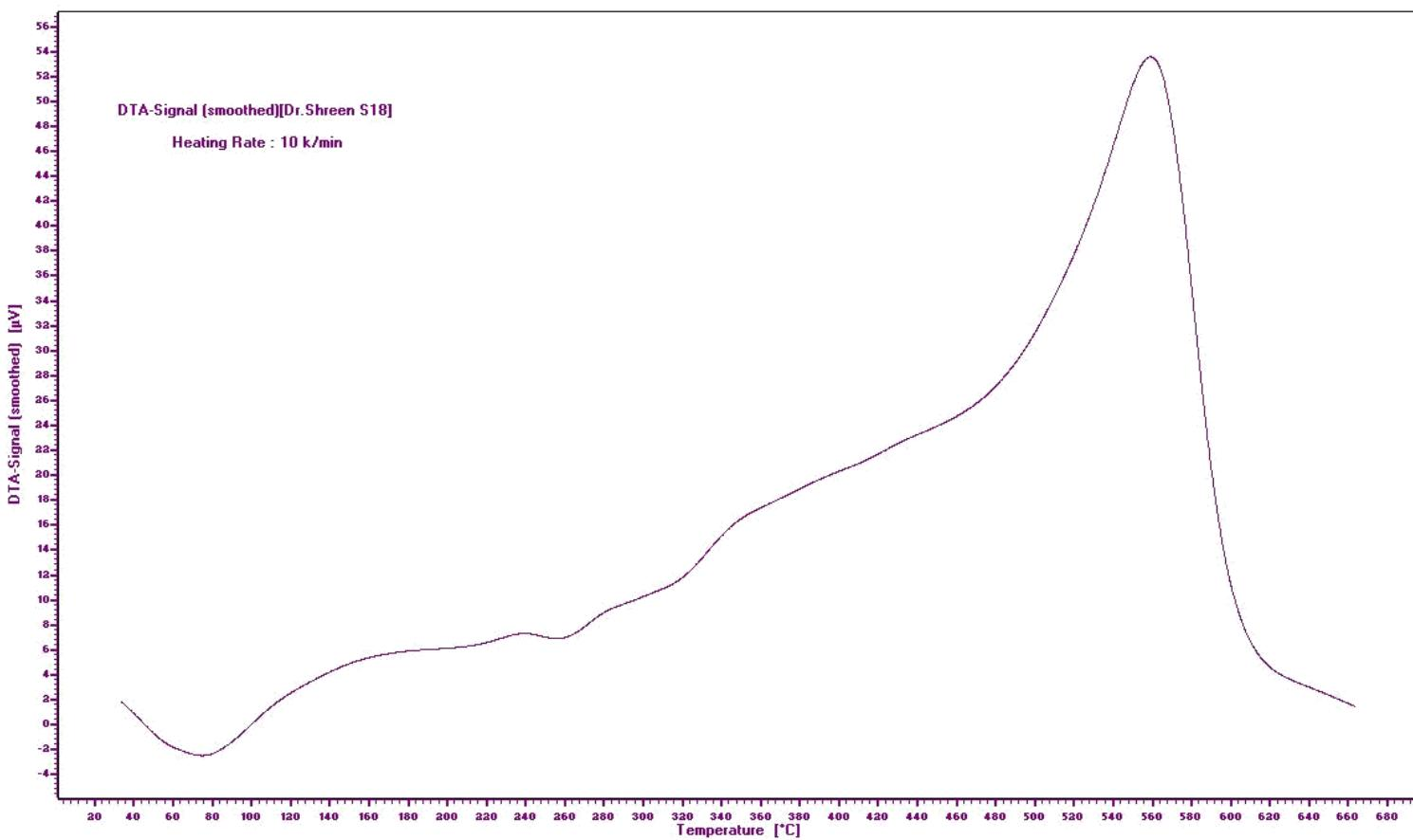
**Figure 41:** DTA of poly[2-(4-(2-(2-aminoethylamino)-2-oxoethylamino)-6-(phenylamino)-1,3,5-triazin-2-ylamino)acetic acid] **29**.
