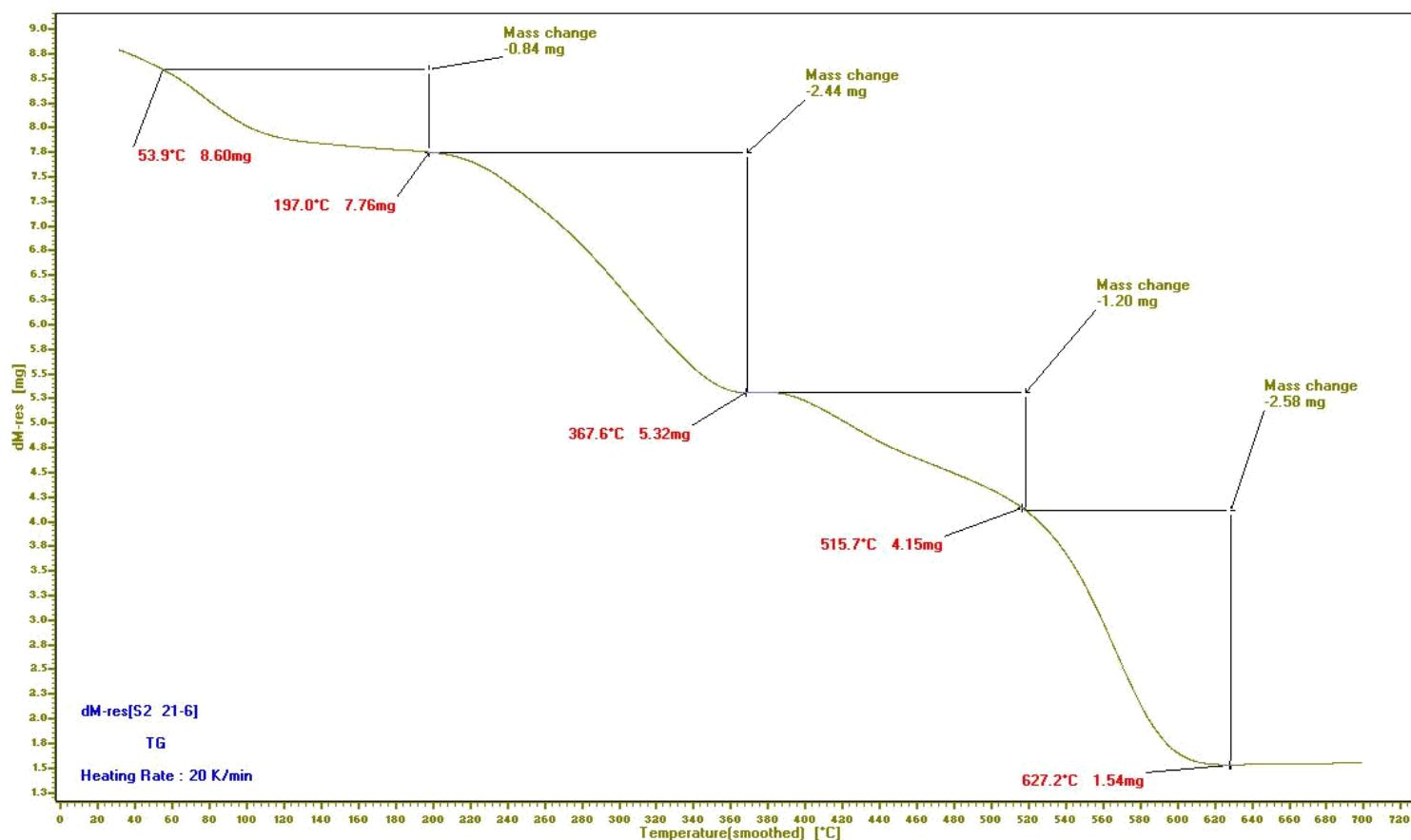
**Figure 19:** TGA of poly[2-(4-(2-(2-aminoethylamino)-2-oxoethylamino)-6-morpholino-1,3,5-triazin-2-ylamino)acetic acid] **25**.
