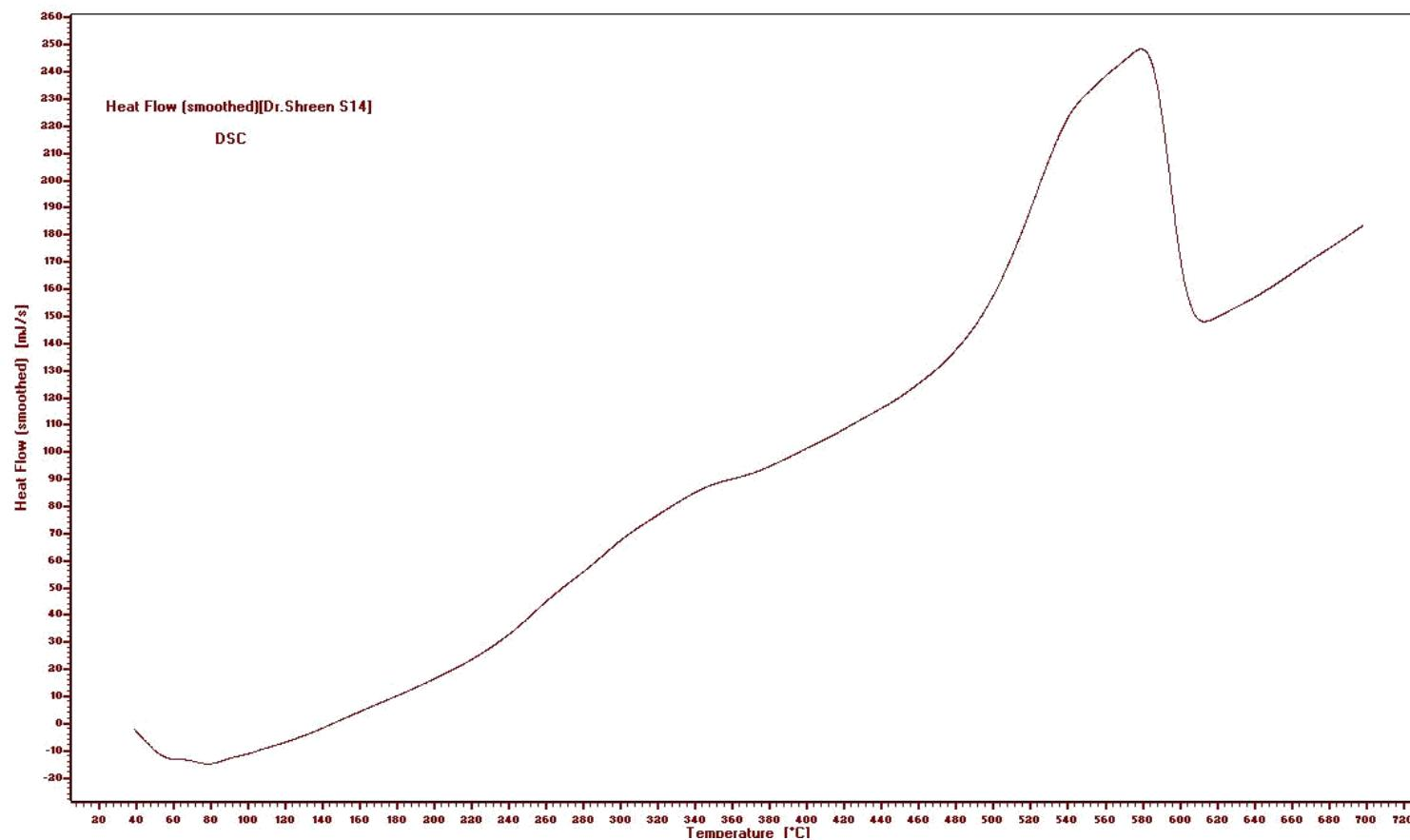
**Figure 37:** DSC of poly[2-(4-(2-(2-aminoethylamino)-2-oxoethylthio)-6-(piperidin-1-yl)-1,3,5-triazin-2-ylthio)acetic acid] **28**.
