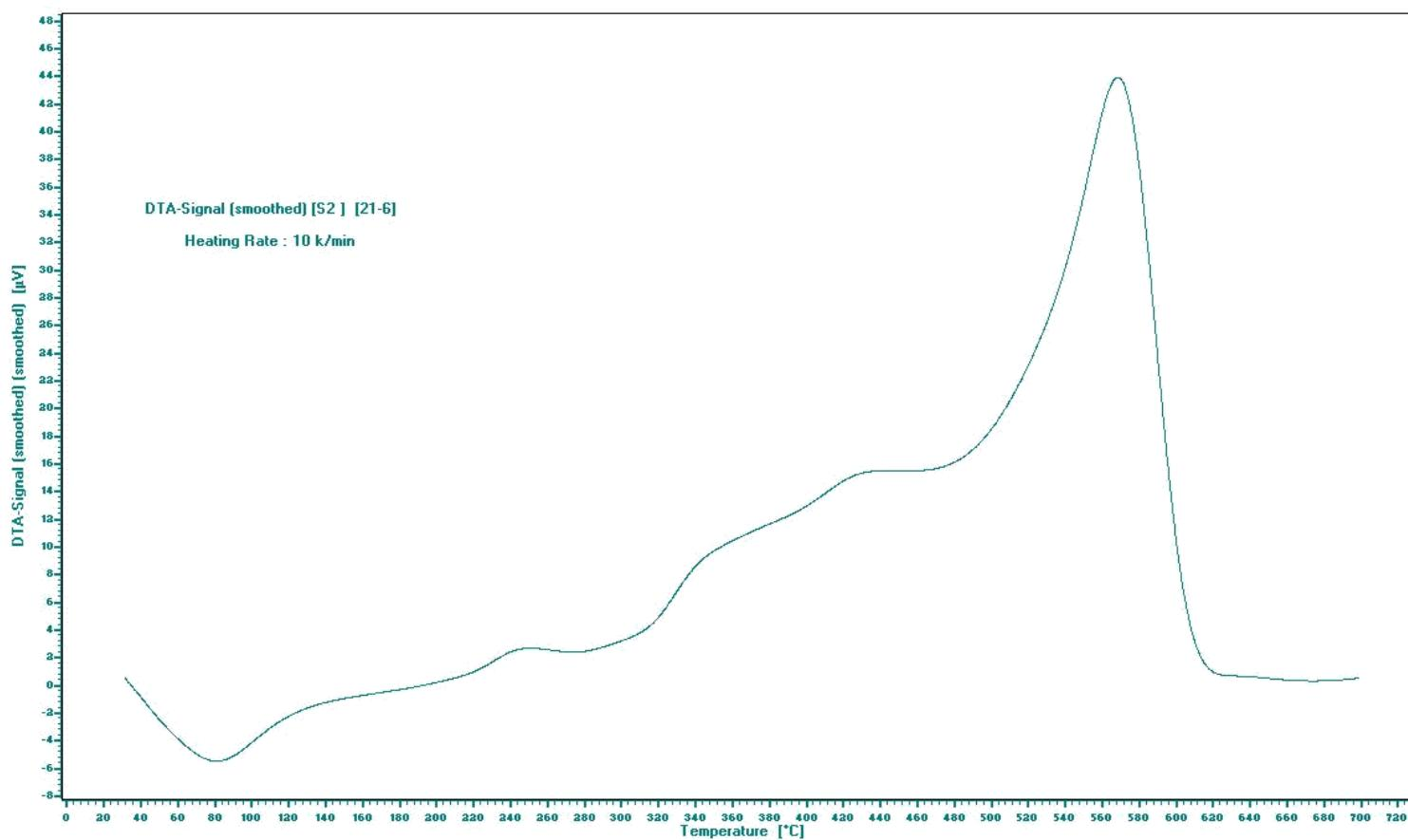
**Figure 21:** DTA of poly[2-(4-(2-(2-aminoethylamino)-2-oxoethylamino)-6-morpholino-1,3,5-triazin-2-ylamino)acetic acid] **25**.
