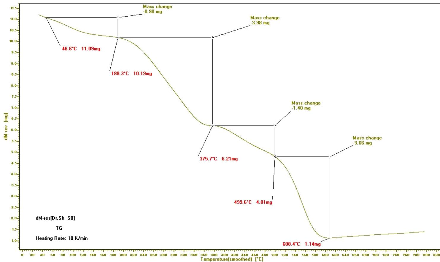
**Figure 29:** TGA of poly[2-(4-(2-(2-aminoethylamino)-2-oxoethylamino)-6-(piperidin-1-yl)-1,3,5-triazin-2-ylamino)acetic acid] 27.
