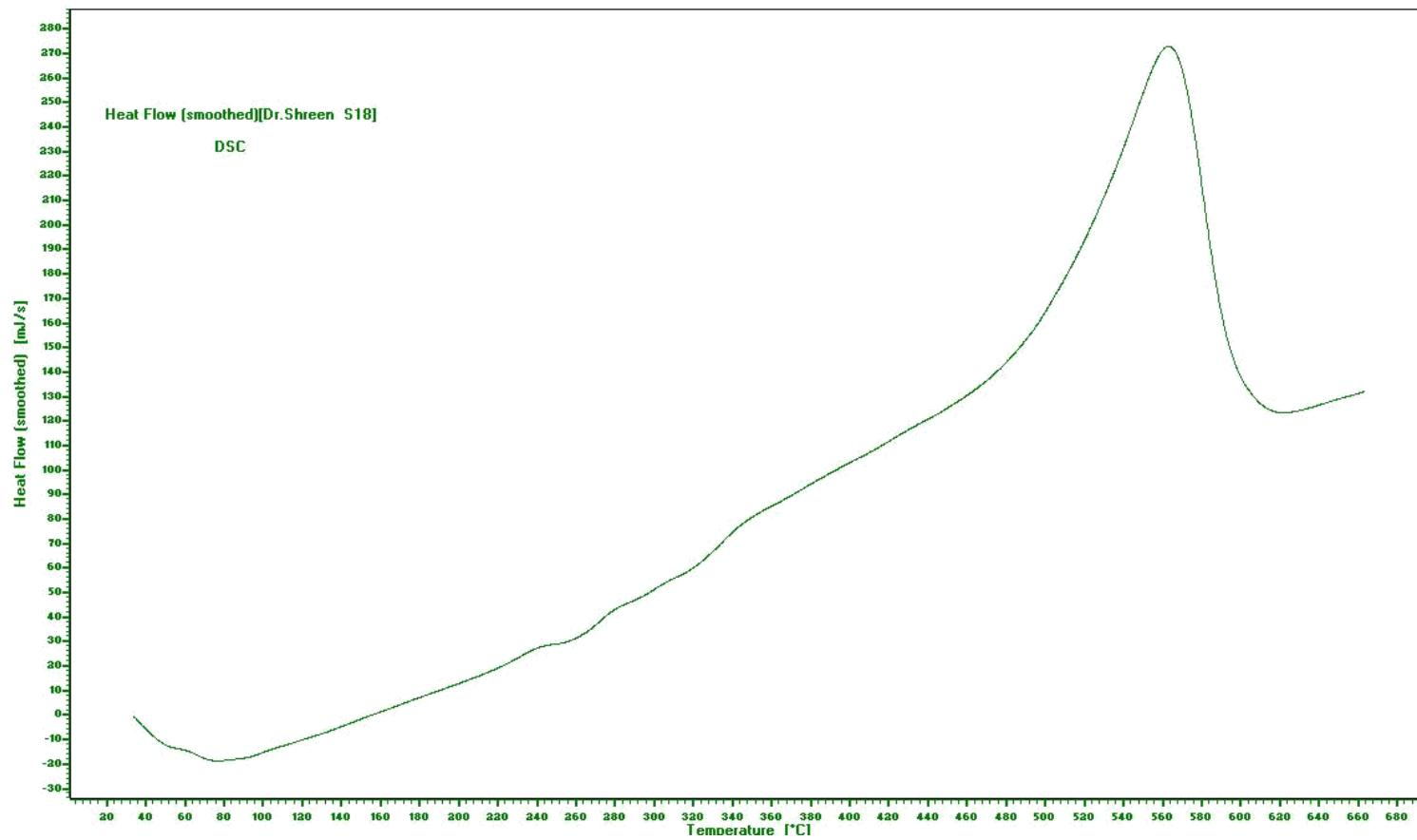
**Figure 42:** DSC of poly[2-(4-(2-(2-aminoethylamino)-2-oxoethylamino)-6-(phenylamino)-1,3,5-triazin-2-ylamino)acetic acid] **29**.
