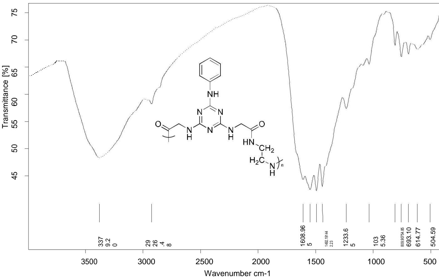
**Figure 38:** IR (KBr) of poly[2-(4-(2-(2-aminoethylamino)-2-oxoethylamino)-6-(phenylamino)-1,3,5-triazin-2-ylamino)acetic acid] **29**.
