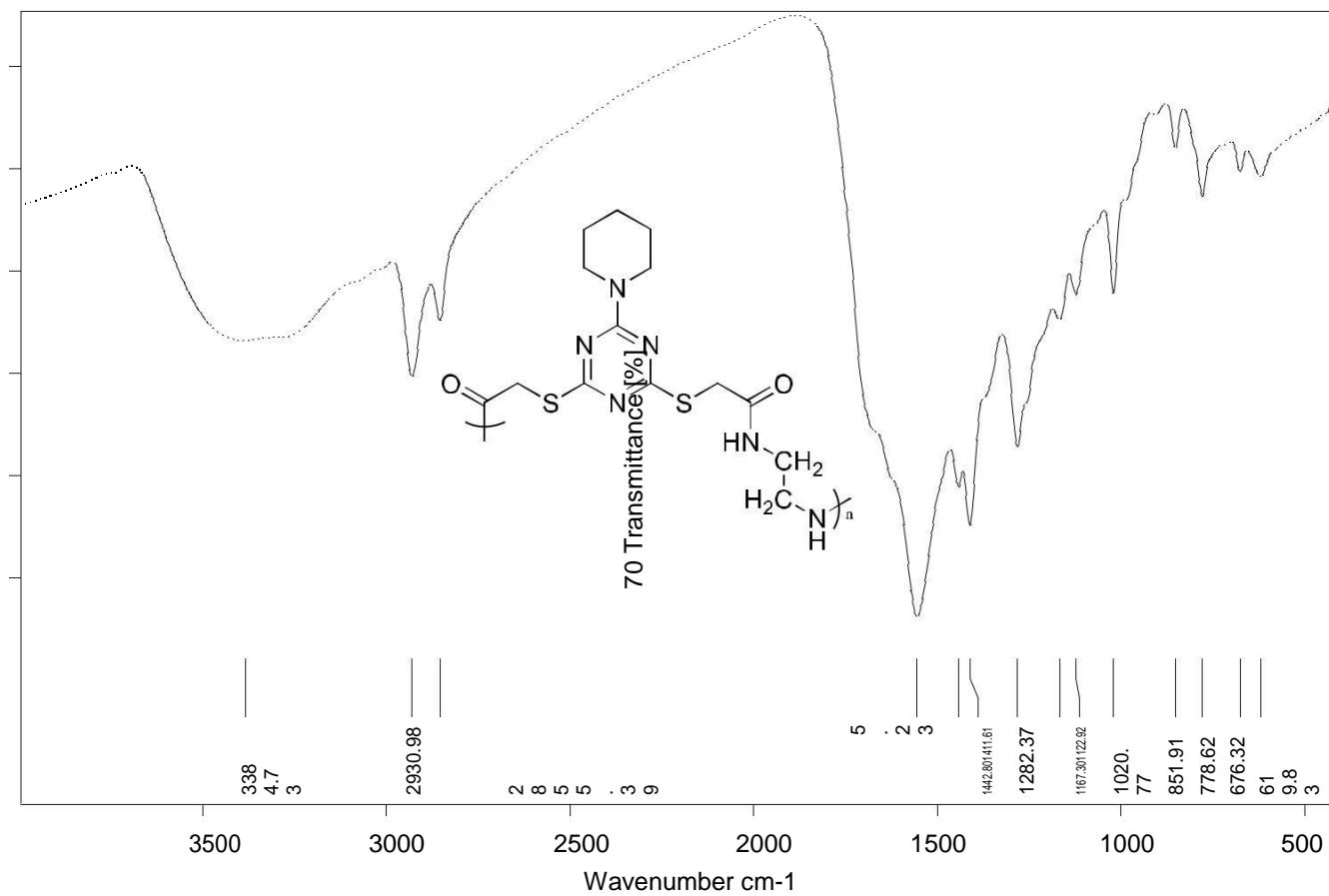
**Figure 33:** IR (KBr) of poly[2-(4-(2-(2-aminoethylamino)-2-oxoethylthio)-6-(piperidin-1-yl)-1,3,5-triazin-2-ylthio)acetic acid] **28.**
