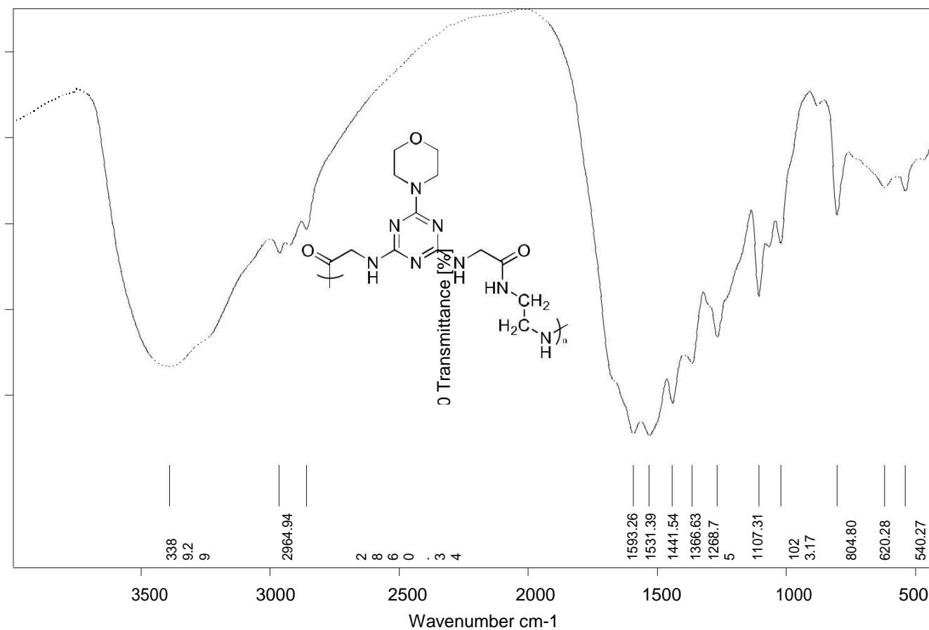
**Figure 18:** IR (KBr) of poly[2-(4-(2-(2-aminoethylamino)-2-oxoethylamino)-6-morpholino-1,3,5-triazin-2-ylamino)acetic acid] 25.
