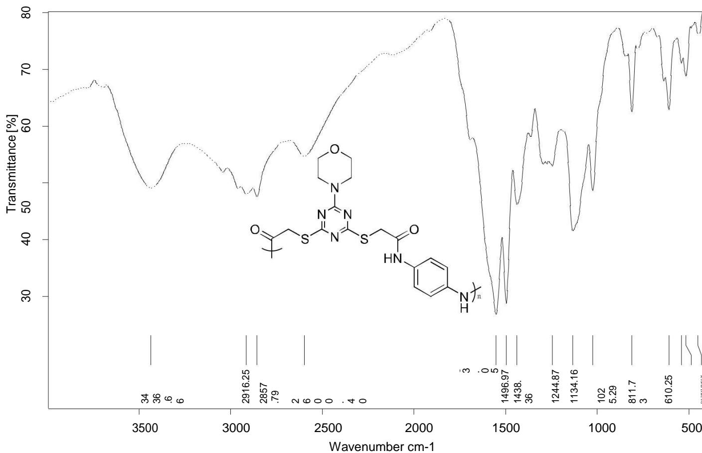
**Figure 113:** IR (KBr) of poly[2-(4-(2-(2-aminoethylamino)-2-oxoethylthio)-6-morpholino-1,3,5-triazin-2-ylthio)acetic acid] **44**.
