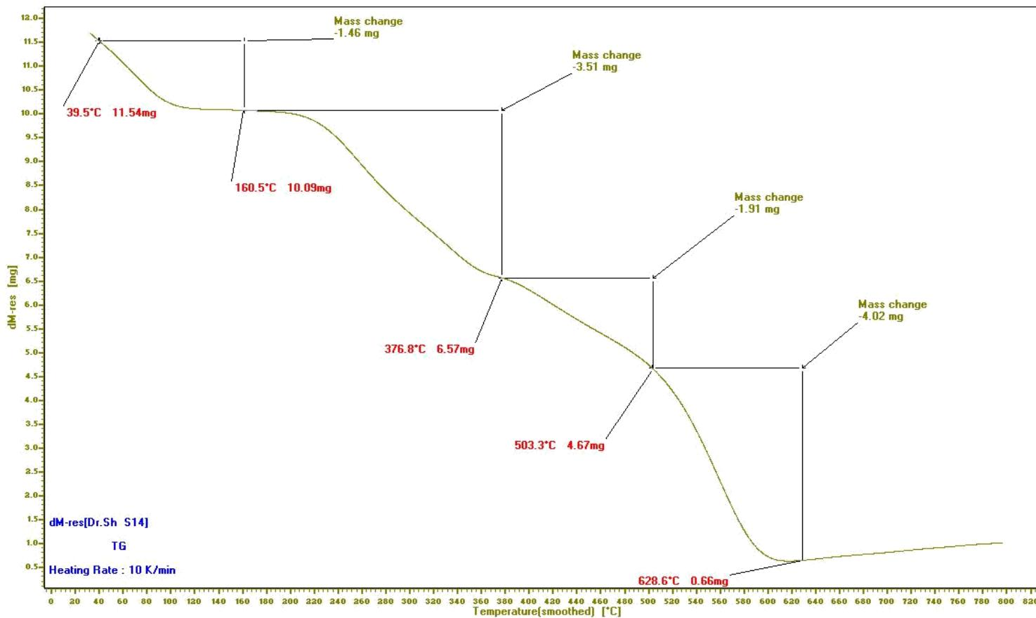
**Figure 34:** TGA of poly[2-(4-(2-(2-aminoethylamino)-2-oxoethylthio)-6-(piperidin-1-yl)-1,3,5-triazin-2-ylthio)acetic acid] **28**.
