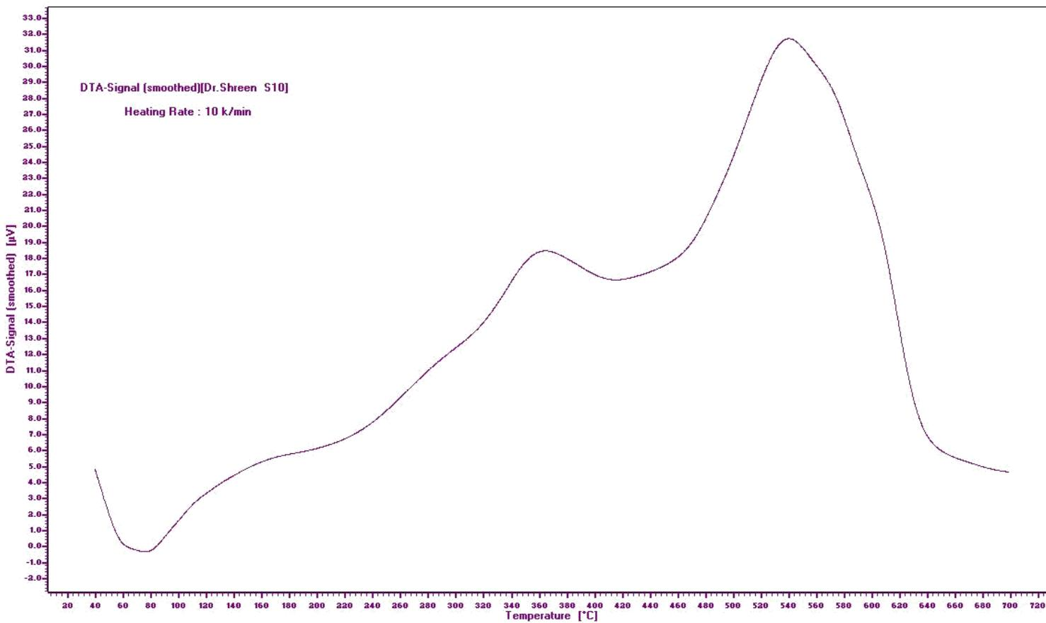
**Figure 26:** DTA of poly[2-(4-(2-(2-aminoethylamino)-2-oxoethylthio)-6-morpholino-1,3,5-triazin-2-ylthio)acetic acid] **26**.
