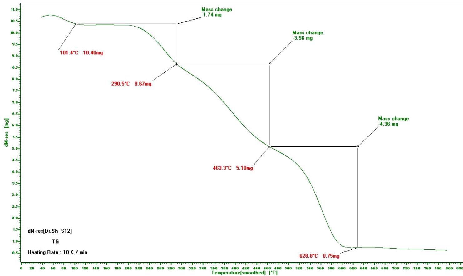
**Figure 54:** TGA of poly[2-(4-(2-(4'-aminobiphenyl-4-ylamino)-2-oxoethylthio)-6-morpholino-1,3,5-triazin-2-ylthio)acetic acid] **32.**
