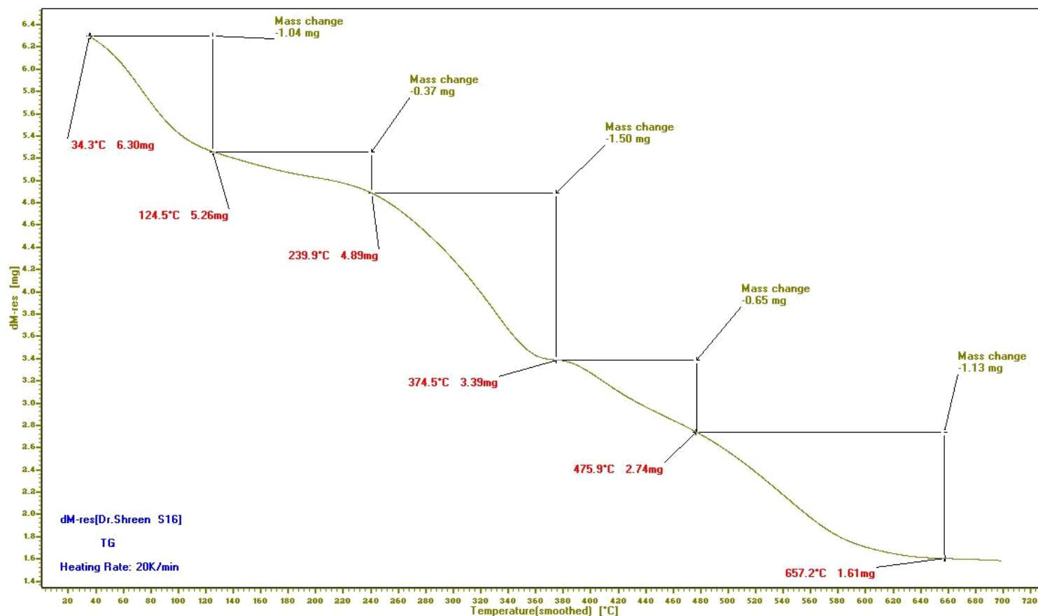
**Figure 44:** TGA of poly[2-(4-(2-(2-aminoethylamino)-2-oxoethylthio)-6-(phenylamino)-1,3,5-triazin-2-ylthio)acetic acid] **30**.
