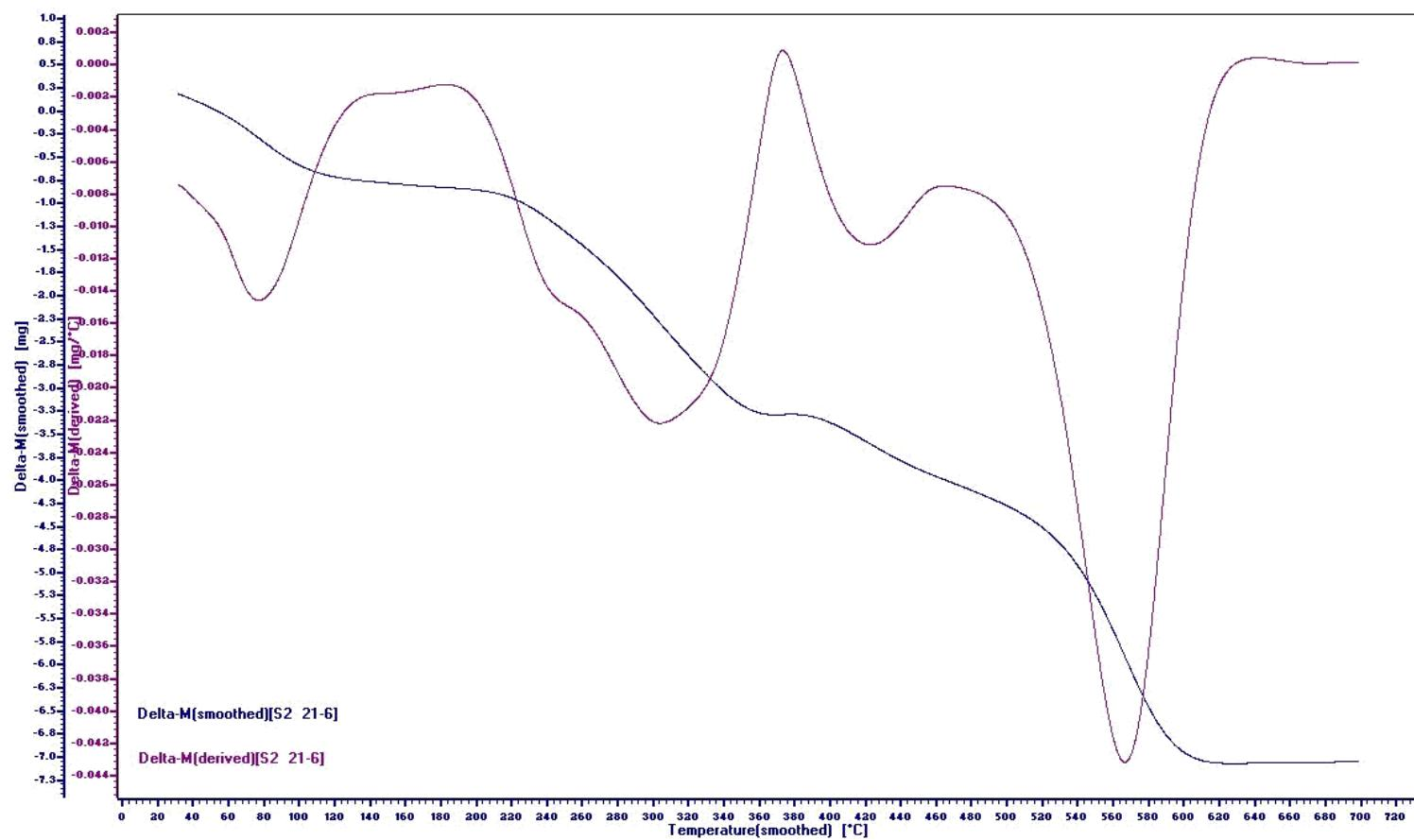
**Figure 20:** TGA/DTG of poly[2-(4-(2-(2-aminoethylamino)-2-oxoethylamino)-6-morpholino-1,3,5-triazin-2-ylamino)acetic acid] 25.
