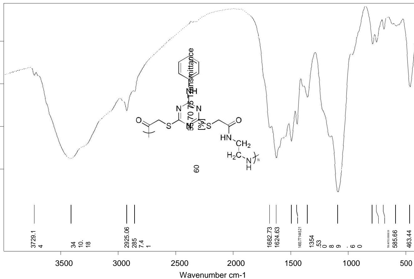
**Figure 43:** IR (KBr) of poly[2-(4-(2-(2-aminoethylamino)-2-oxoethylthio)-6-(phenylamino)-1,3,5-triazin-2-ylthio)acetic acid] **30**.
