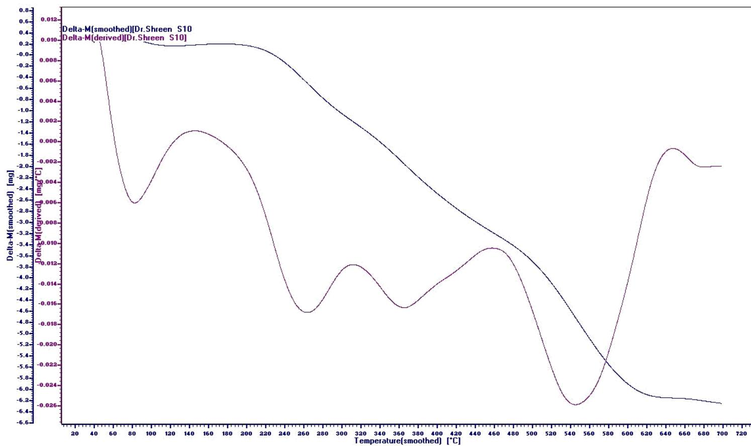
**Figure 25:** TGA/DTG of poly[2-(4-(2-(2-aminoethylamino)-2-oxoethylthio)-6-morpholino-1,3,5-triazin-2-ylthio)acetic acid] 26.
