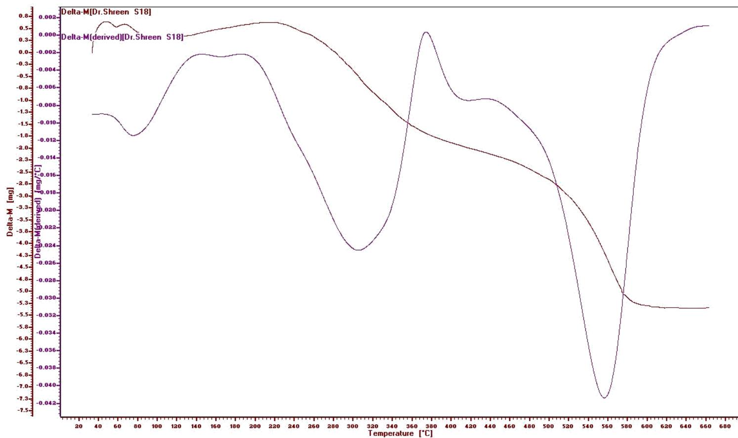
**Figure 40:** TGA/DTG of poly[2-(4-(2-(2-aminoethylamino)-2-oxoethylamino)-6-(phenylamino)-1,3,5-triazin-2-ylamino)acetic acid]
