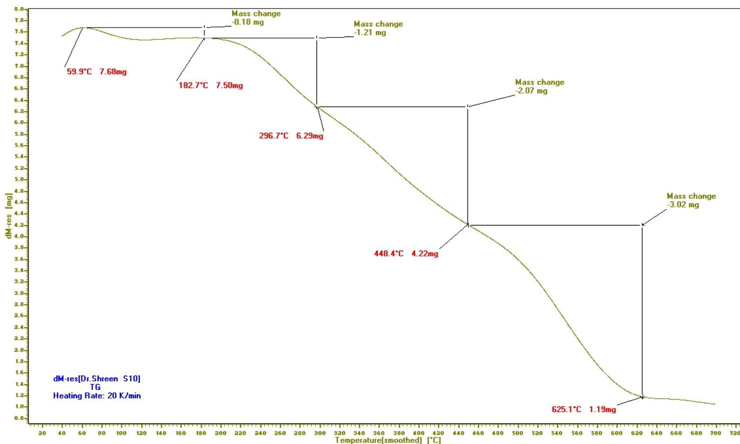
**Figure 24:** TGA of poly[2-(4-(2-(2-aminoethylamino)-2-oxoethylthio)-6-morpholino-1,3,5-triazin-2-ylthio)acetic acid] **26.**
