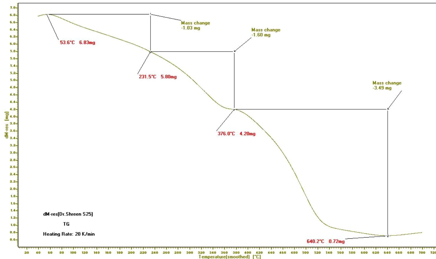
**Figure 134:** TGA of poly[2-(4-(2-(4-aminophenylamino)-2-oxoethylthio)-6-(phenylamino)-1,3,5-triazin-2-ylthio)acetic acid] **48**.
