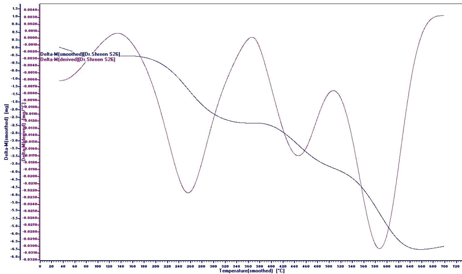
**Figure 125:** TGA/DTG of poly[2-(4-(2-(4-aminophenylamino)-2-oxoethylthio)-6-(piperidin-1-yl)-1,3,5-triazin-2-ylthio)acetic acid] **46**.
