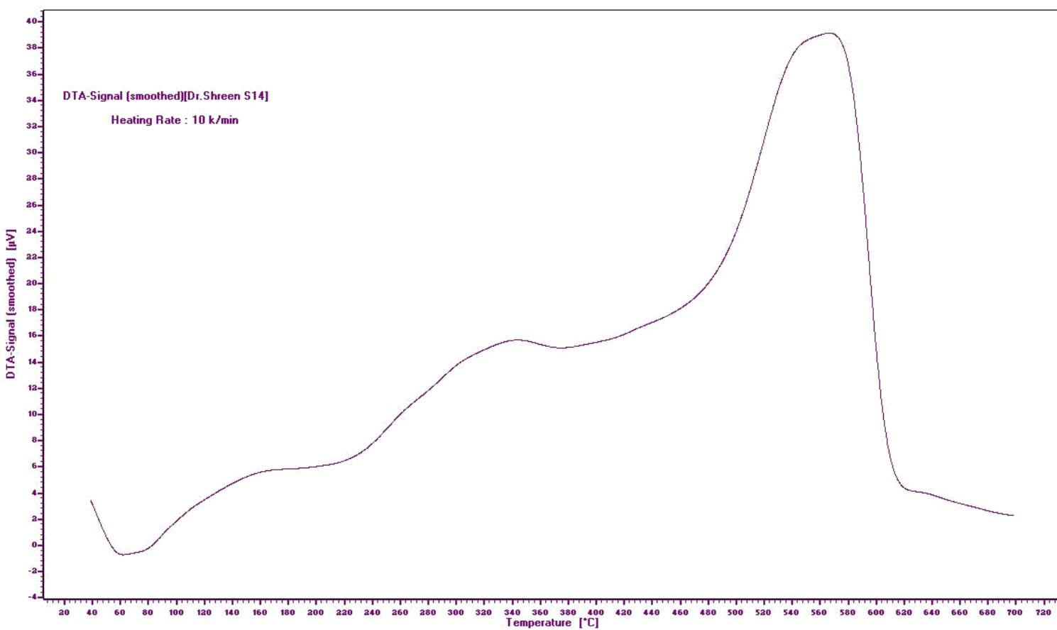
**Figure 36:** DTA of poly[2-(4-(2-(2-aminoethylamino)-2-oxoethylthio)-6-(piperidin-1-yl)-1,3,5-triazin-2-ylthio)acetic acid] **28**.
