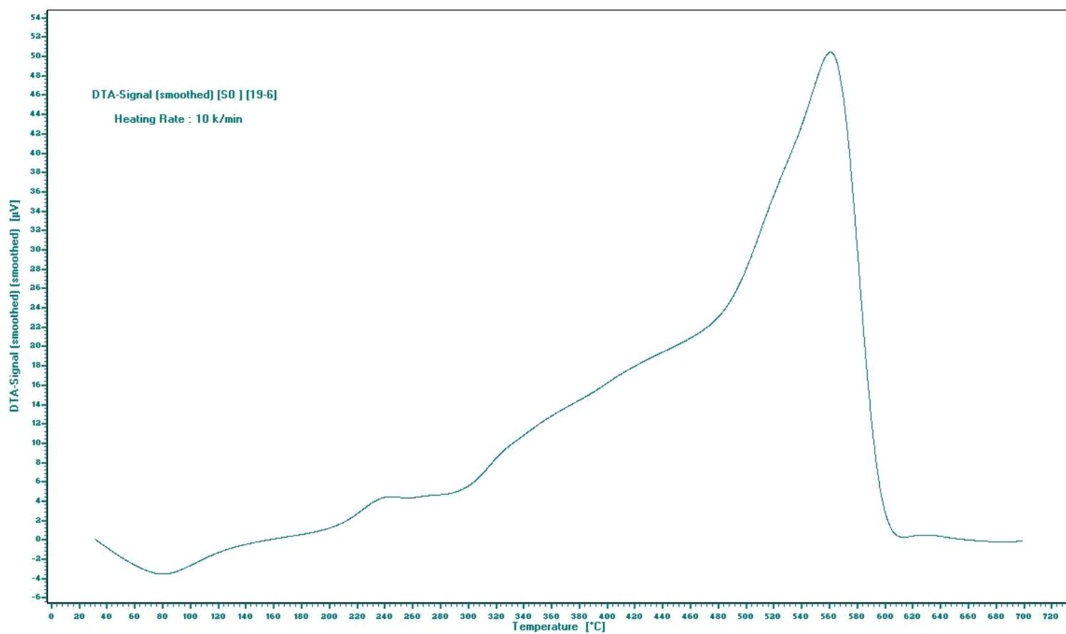
**Figure 31:** DTA of poly[2-(4-(2-(2-aminoethylamino)-2-oxoethylamino)-6-(piperidin-1-yl)-1,3,5-triazin-2-ylamino)acetic acid] 27.
