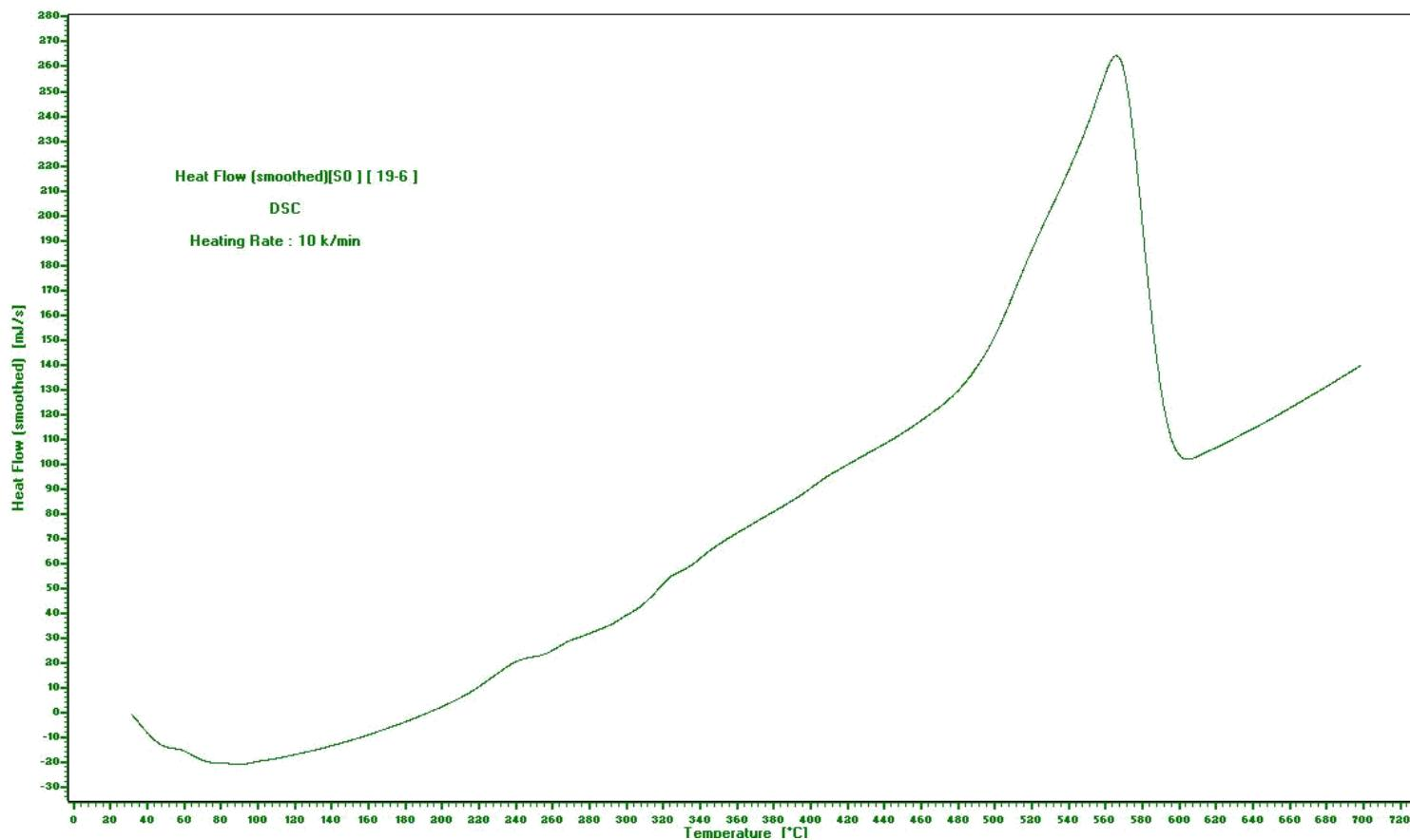
**Figure 32:** DSC of poly[2-(4-(2-(2-aminoethylamino)-2-oxoethylamino)-6-(piperidin-1-yl)-1,3,5-triazin-2-ylamino)acetic acid] 27.
