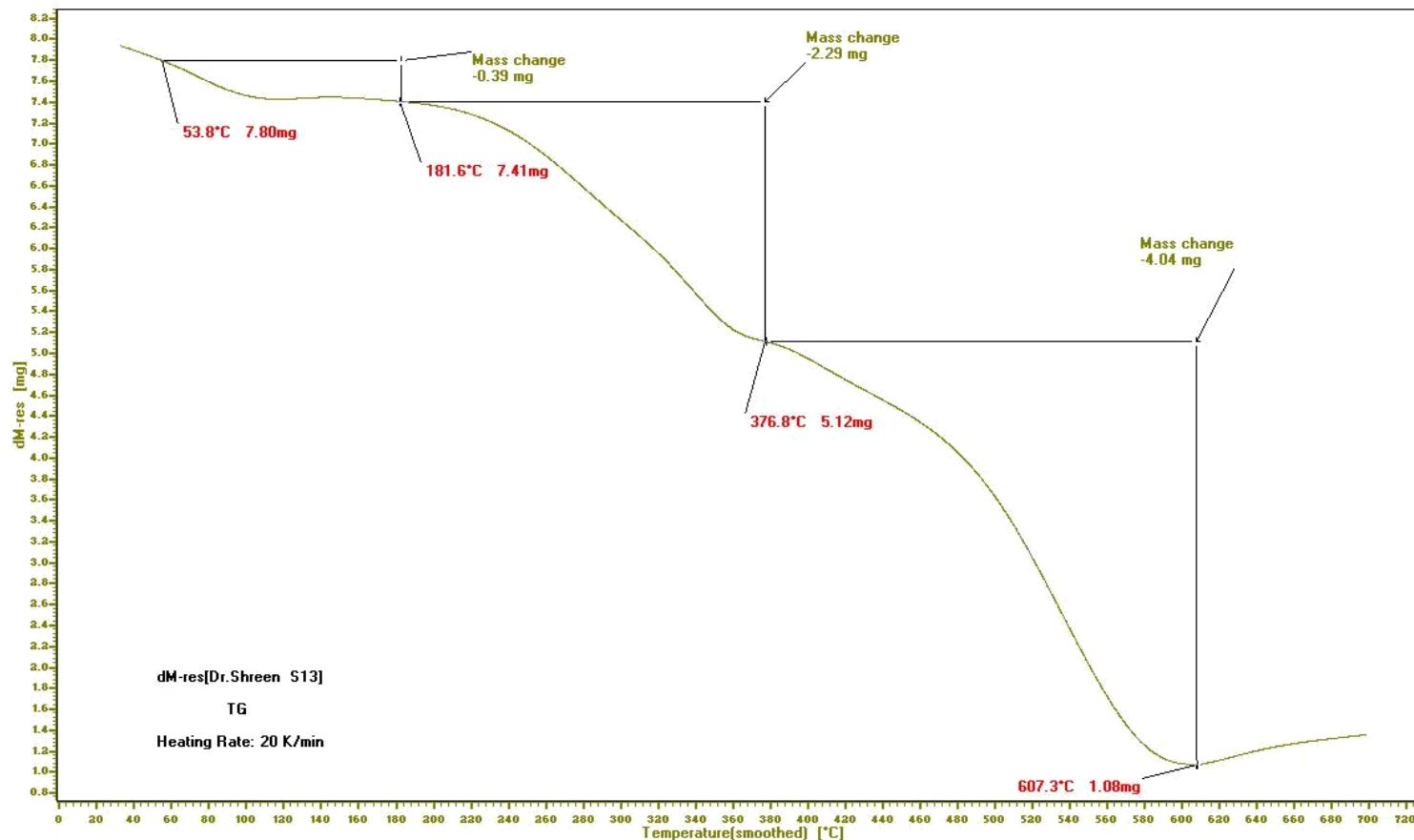
**Figure 114:** TGA of poly[2-(4-(2-(2-aminoethylamino)-2-oxoethylthio)-6-morpholino-1,3,5-triazin-2-ylthio)acetic acid] **44.**
