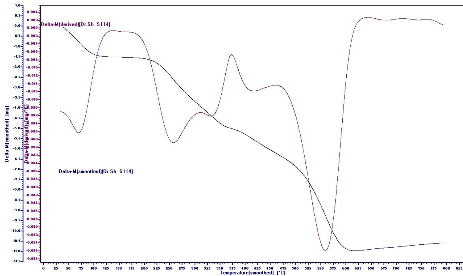
**Figure 35:** TGA/DTG of poly[2-(4-(2-(2-aminoethylamino)-2-oxoethylthio)-6-(piperidin-1-yl)-1,3,5-triazin-2-ylthio)acetic acid] **28**.
