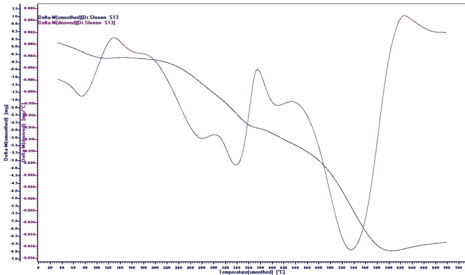
**Figure 115:** TGA/DTG of poly[2-(4-(2-(2-aminoethylamino)-2-oxoethylthio)-6-morpholino-1,3,5-triazin-2-ylthio)acetic acid] **44**.
