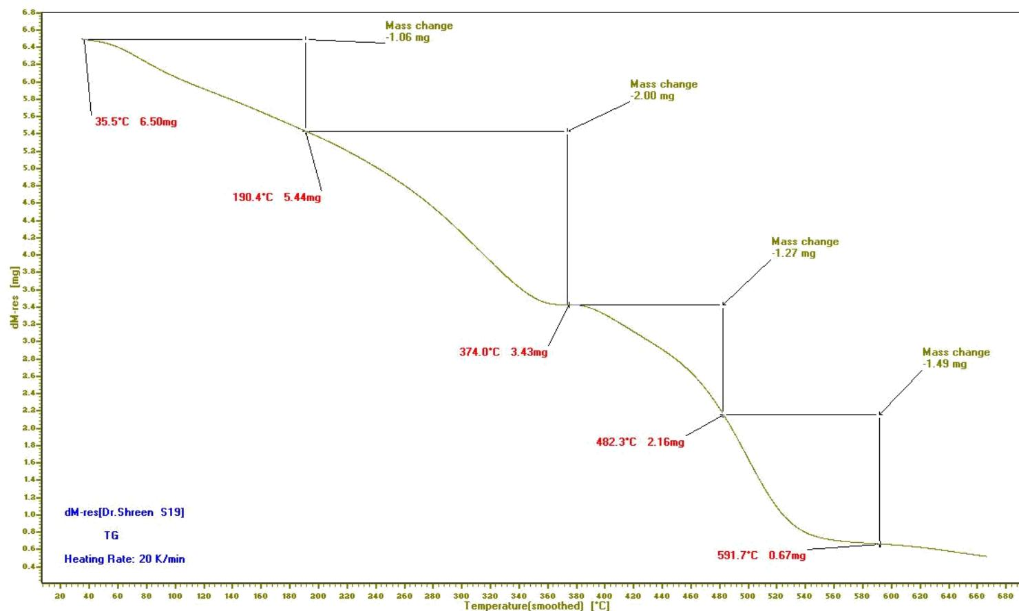
**Figure 74:** TGA of poly[2-(4-(2-(4'-aminobiphenyl-4-ylamino)-2-oxoethylthio)-6-(phenylamino)-1,3,5-triazin-2-ylthio)acetic acid] **36**.
