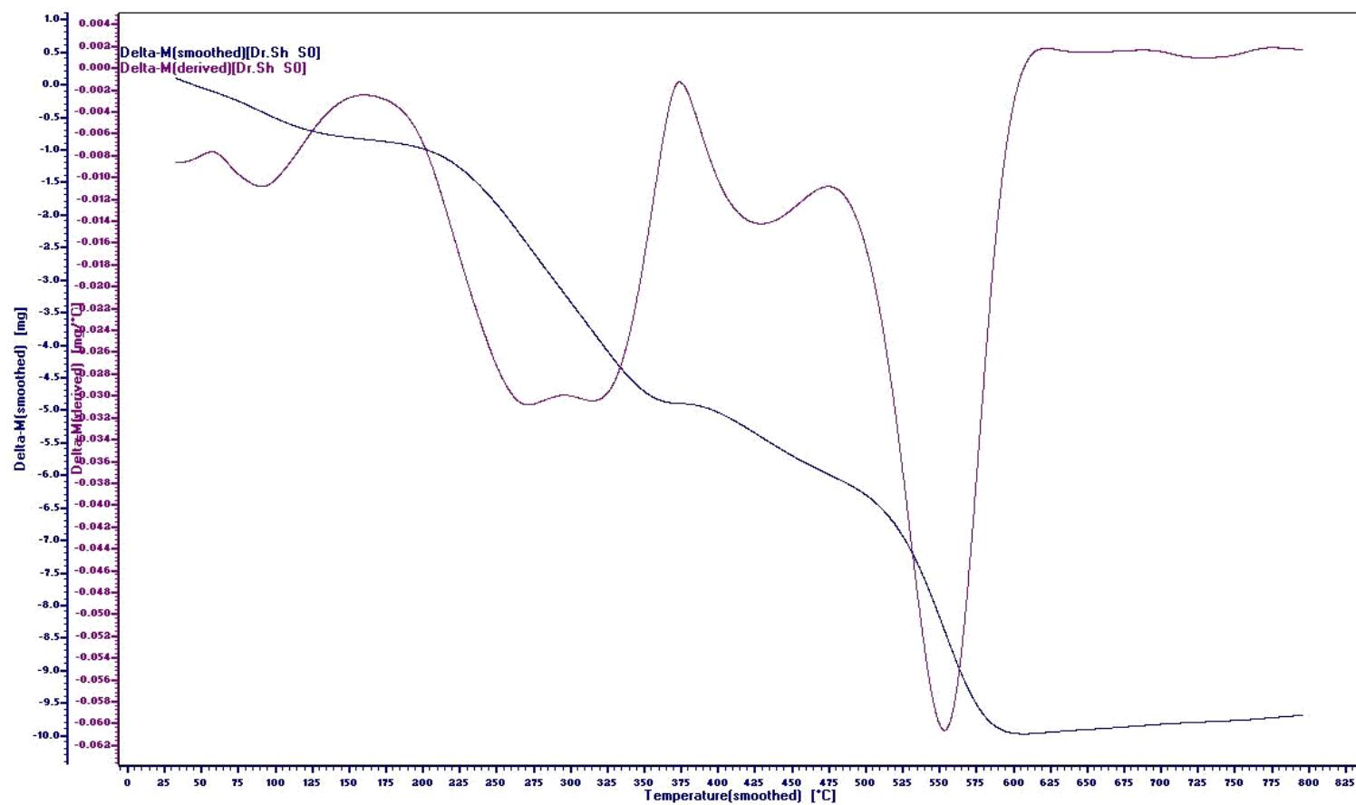
**Figure 30:** TGA/DTG of poly[2-(4-(2-(2-aminoethylamino)-2-oxoethylamino)-6-(piperidin-1-yl)-1,3,5-triazin-2-ylamino)acetic acid]
