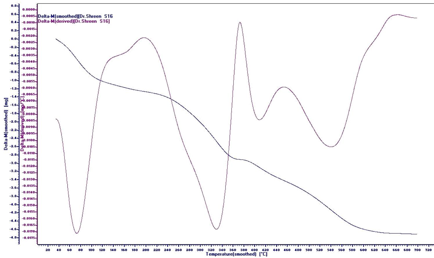
**Figure 45:** TGA/DTG of poly[2-(4-(2-(2-aminoethylamino)-2-oxoethylthio)-6-(phenylamino)-1,3,5-triazin-2-ylthio)acetic acid] **30**.
