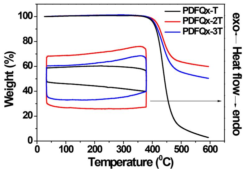
**Fig. S1** TGA and DSC (insert) thermograms of PDFQ<sub>x</sub>-T, PDFQ<sub>x</sub>-2T and PDFQ<sub>x</sub>-3T.
