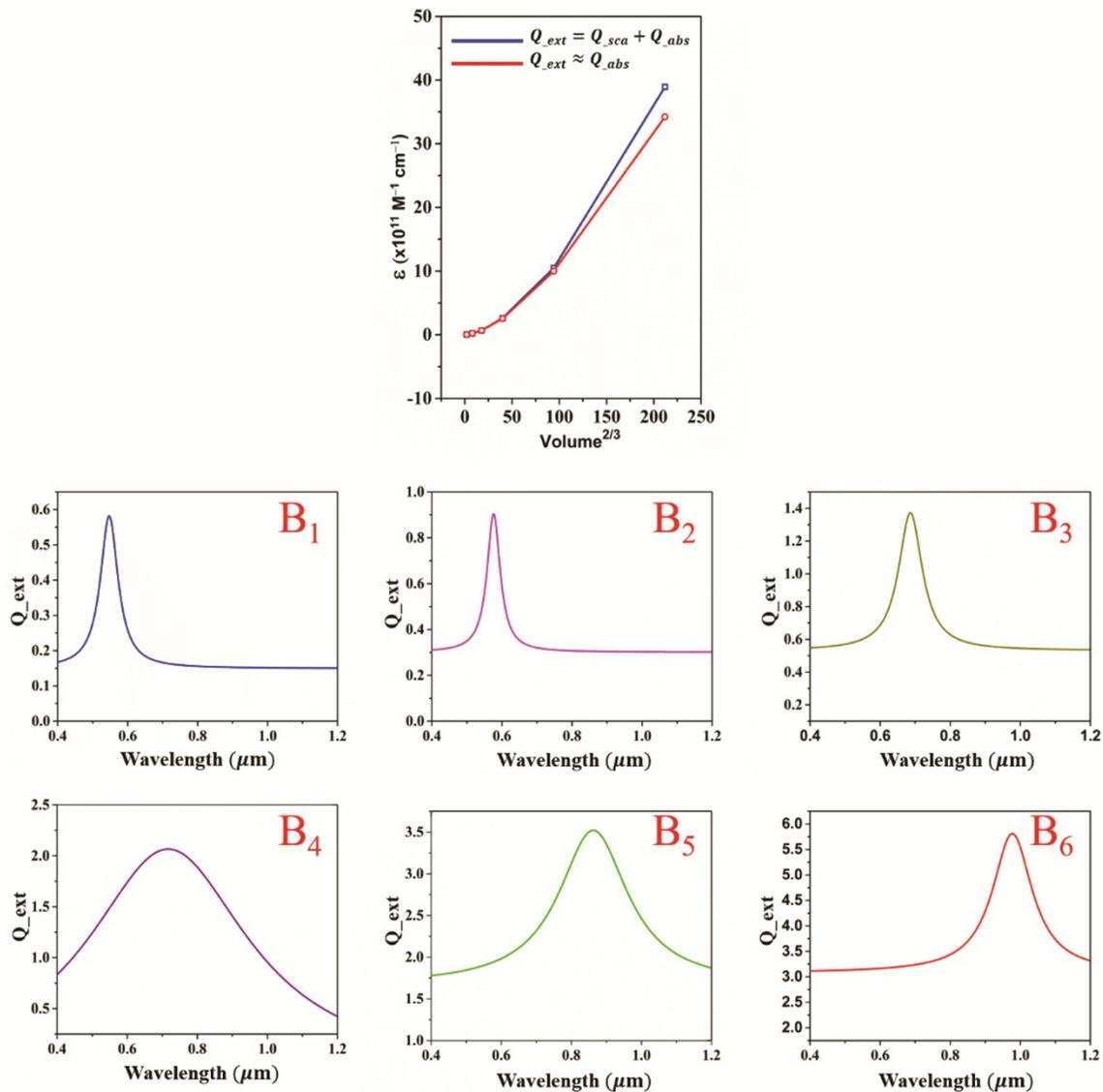
**Figure S3:** (A) Variation of molar extinction coefficient ( $\epsilon$ ) with the volume of the HHog nanoparticles and SPR maxima (in  $\mu\text{m}$ ) for different tip-to-tip distances ( $B_1$ :  $9 \pm 1\text{nm}$ ,  $B_2$ :  $15 \pm 1\text{nm}$ ,  $B_3$ :  $23 \pm 2\text{nm}$ ,  $B_4$ :  $35 \pm 3\text{nm}$ ,  $B_5$ :  $55 \pm 3\text{nm}$ ,  $B_6$ :  $85 \pm 3\text{nm}$ ), nanoparticles.
