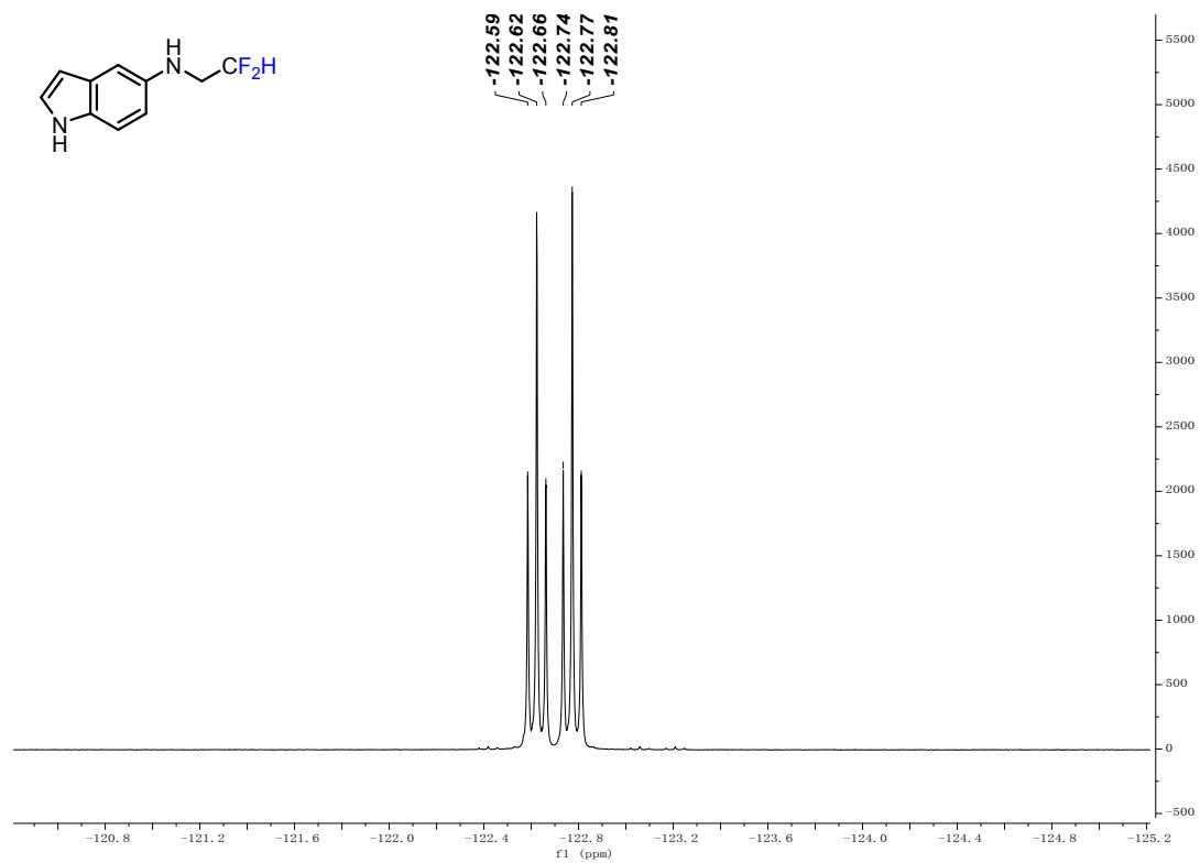
**<sup>19</sup>F {<sup>1</sup>H} NMR** ( $\text{CDCl}_3$ , 376 MHz) of **10f**
