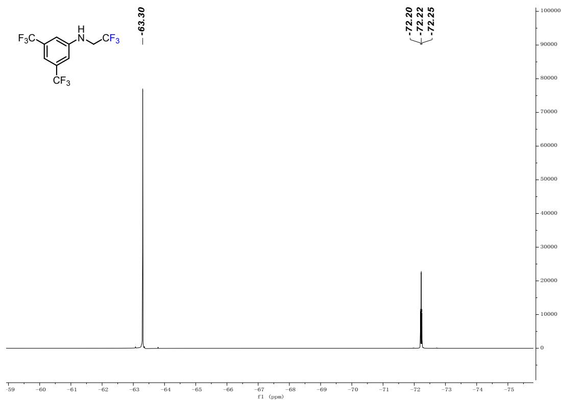
**<sup>19</sup>F {<sup>1</sup>H} NMR (CDCl<sub>3</sub>, 376 MHz) of 3I**
