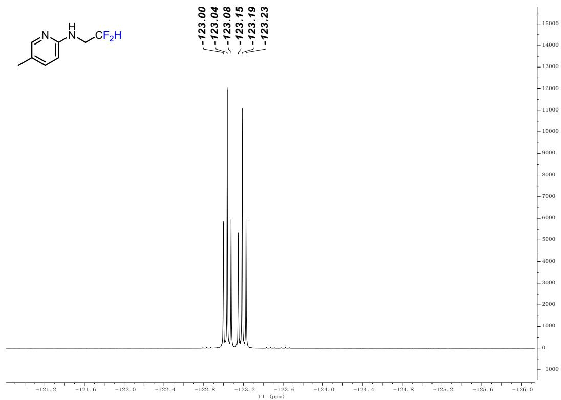
**<sup>19</sup>F {<sup>1</sup>H} NMR (CDCl<sub>3</sub>, 376 MHz) of 10d**
