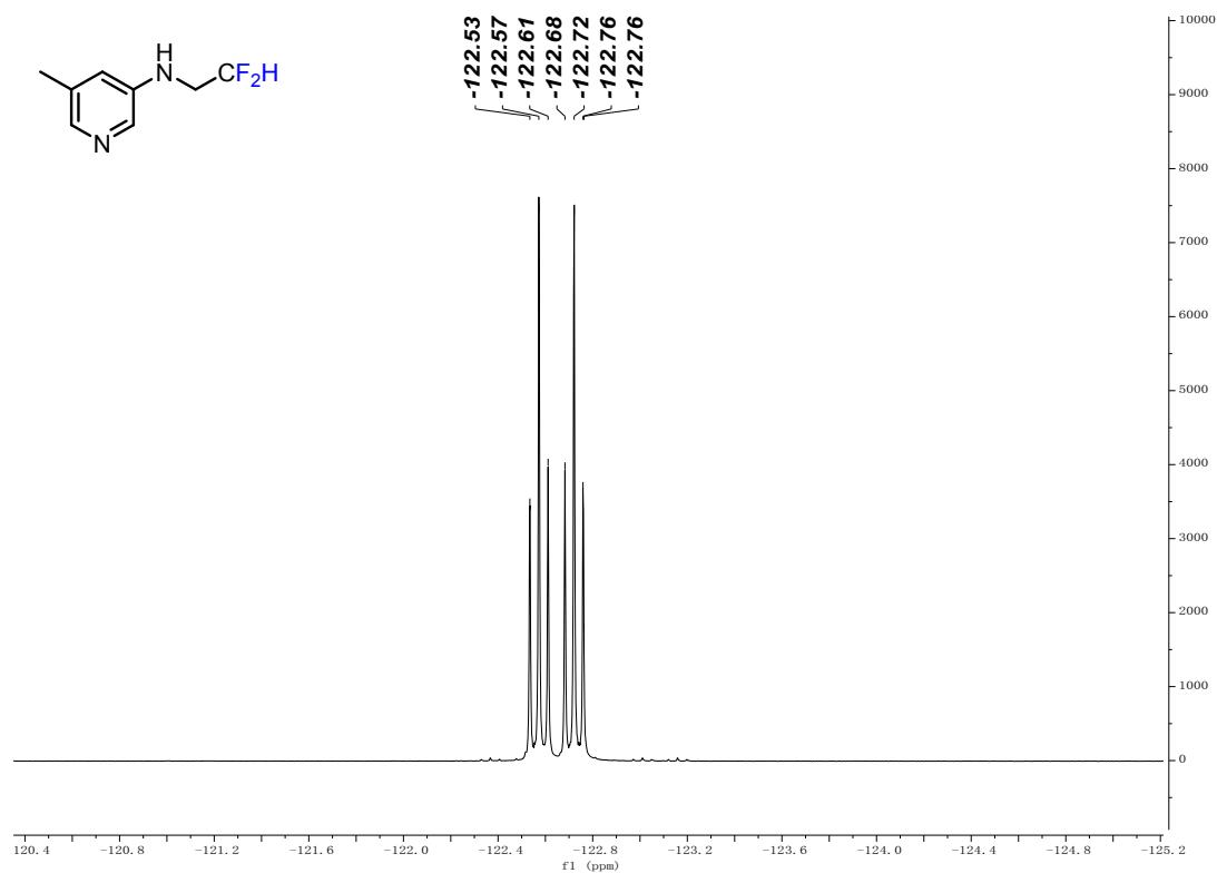
**<sup>19</sup>F {<sup>1</sup>H} NMR** ( $\text{CDCl}_3$ , 376 MHz) of **10c**
