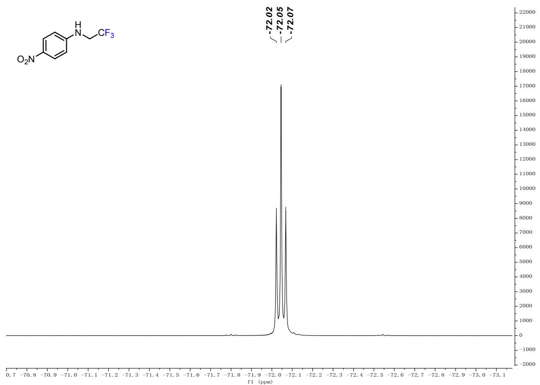
**<sup>19</sup>F {<sup>1</sup>H} NMR (CDCl<sub>3</sub>, 376 MHz) of 3f**
