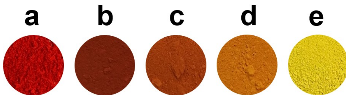
Fig. S6 The color of (a) \text{CdSe} -DETA, (b) \text{CdS}_{0.2}\text{Se}_{0.8} -DETA, (c) \text{CdS}_{0.5}\text{Se}_{0.5} -DETA, (d) \text{CdS}_{0.8}\text{Se}_{0.2} -DETA and (e) \text{CdS} -DETA.
