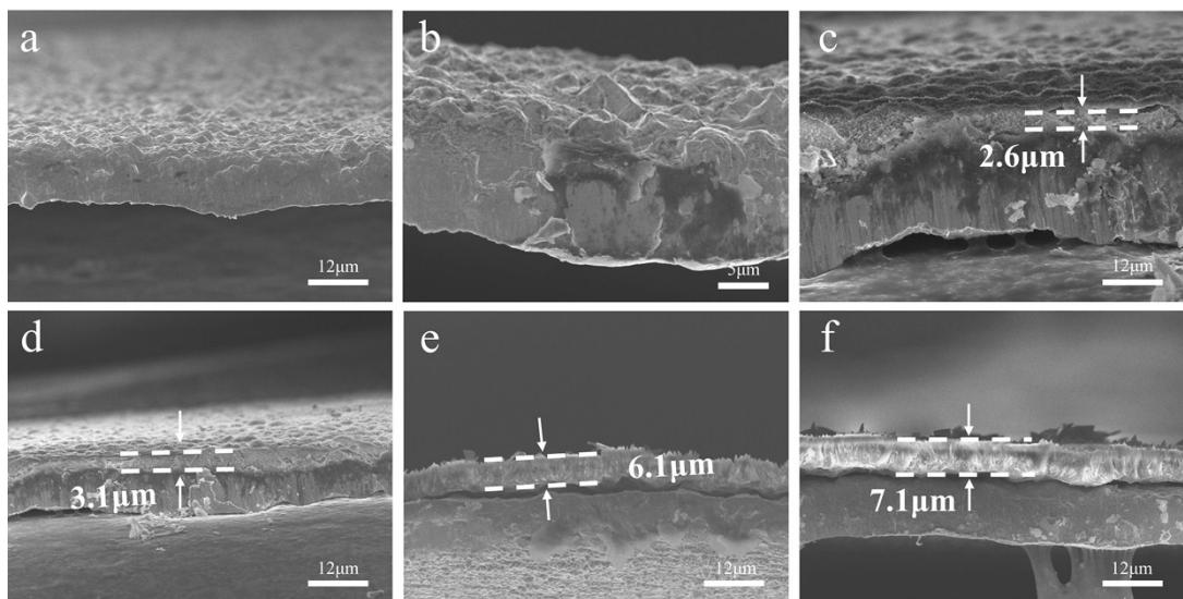
**Fig. S4** Cross-sectional SEM images of the Zn-MOF film on Cu foil with different crystallization time (a) 0min, (b) 10 min, (c) 30 min, (d) 1 h, (d) 3 h, (d) 5 h.
