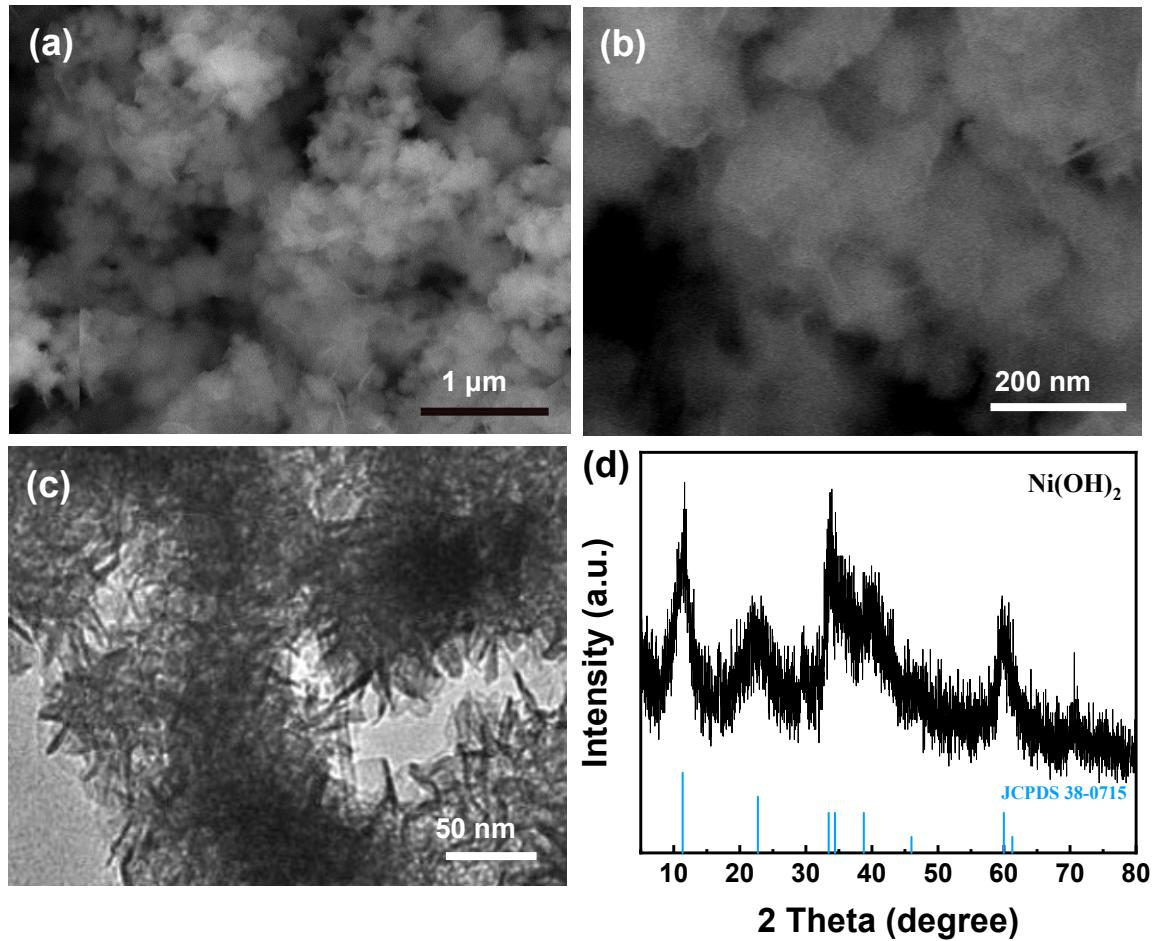
**Fig. S11.** (a, b) SEM and TEM images of the  $\text{Ni}(\text{OH})_2$ . (d) XRD patterns of  $\text{Ni}(\text{OH})_2$ .
