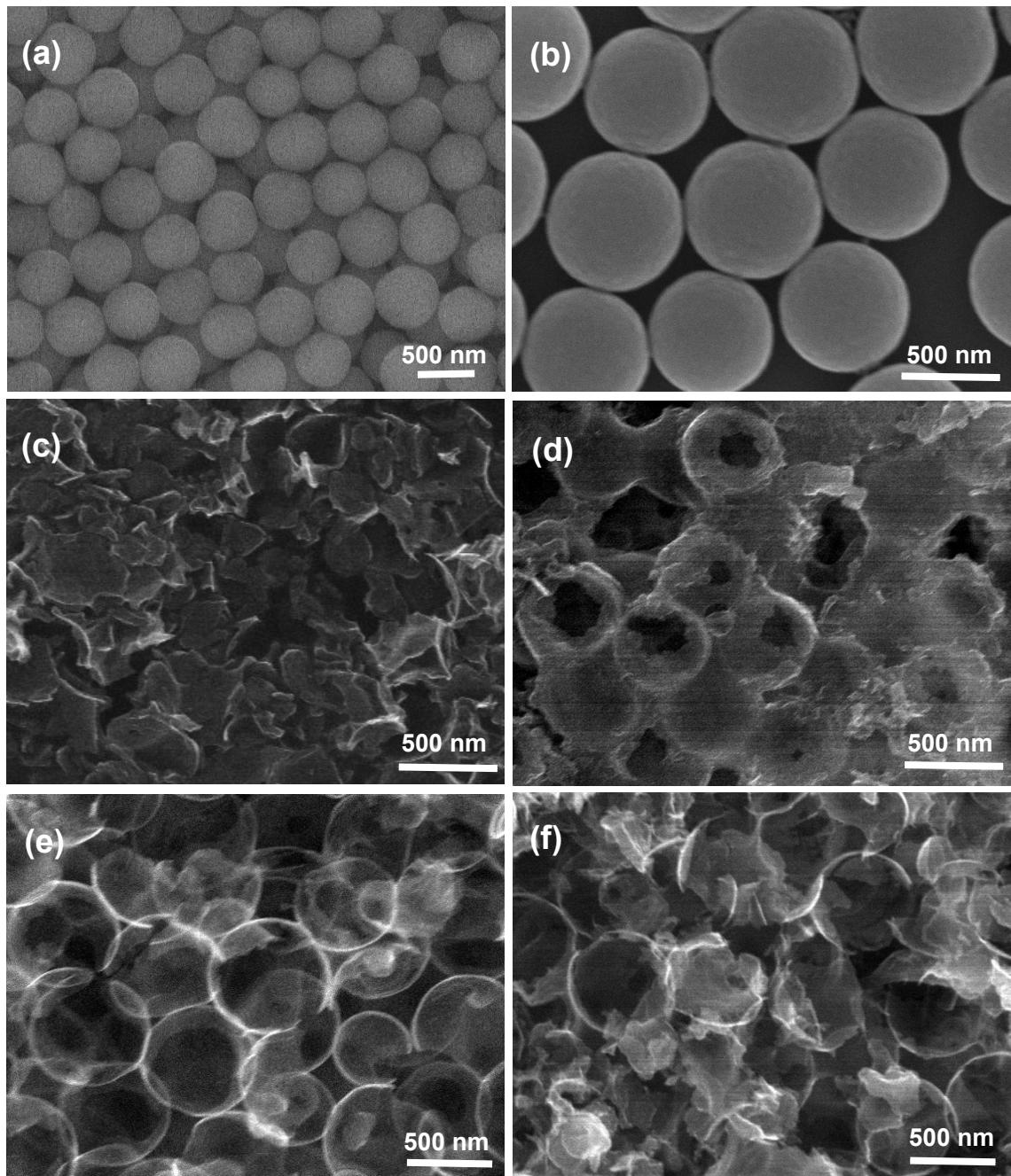
**Fig. S1.** SEM images of the (a, b)  $\text{SiO}_2$ , (c) BC-0, (d) BC-0.25, (e) BC-0.5, (f) BC-1.
