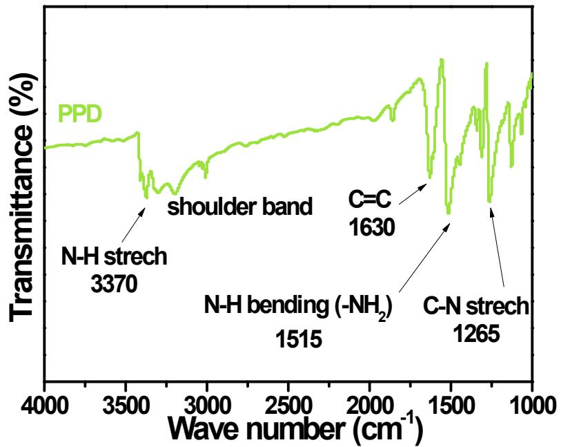
Fig. S5. FTIR spectra of PPD.
