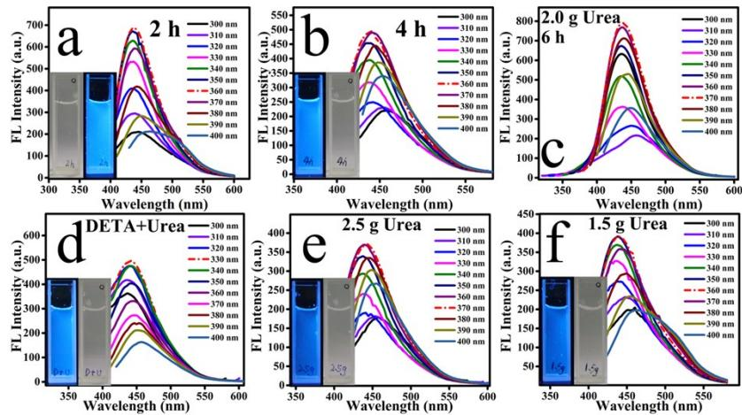
**Fig. S2** Fluorescence spectra of the  $\text{Fe}_3\text{O}_4$ -CDs synthesized under (a) 2 h, (b) 4 h, (c) 6 h, (d) DETA+Urea, (e) 2.5 g Urea, (f) 1.5 g Urea.
