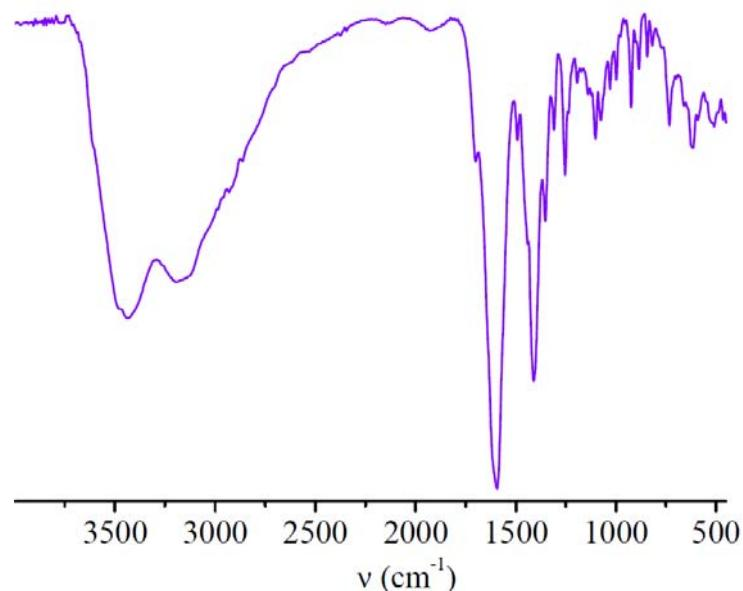
**Fig. S7** IR spectrum of  $(\text{NH}_4)_2\text{Na}[\text{Gd}(\text{EDTA})(\text{H}_2\text{cit})]\cdot 4\text{H}_2\text{O}$  (**3**)
