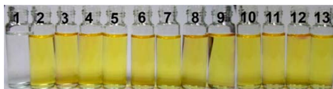
Figure S8. Visible color changes of probe 1 (10 μM) in the presence of various anions (20 μM). 1) CN - ; 2) blank; 3) F - ; 4) Cl - ; 5) Br - ; 6) I - ; 7) HSO 3 - ; 8) CH 3 COO - ; 9) ClO 4 - ; 10) H 2 PO 4 - ; 11) HCO 3 - ; 12) NO 3 - ; 13) SCN - .
