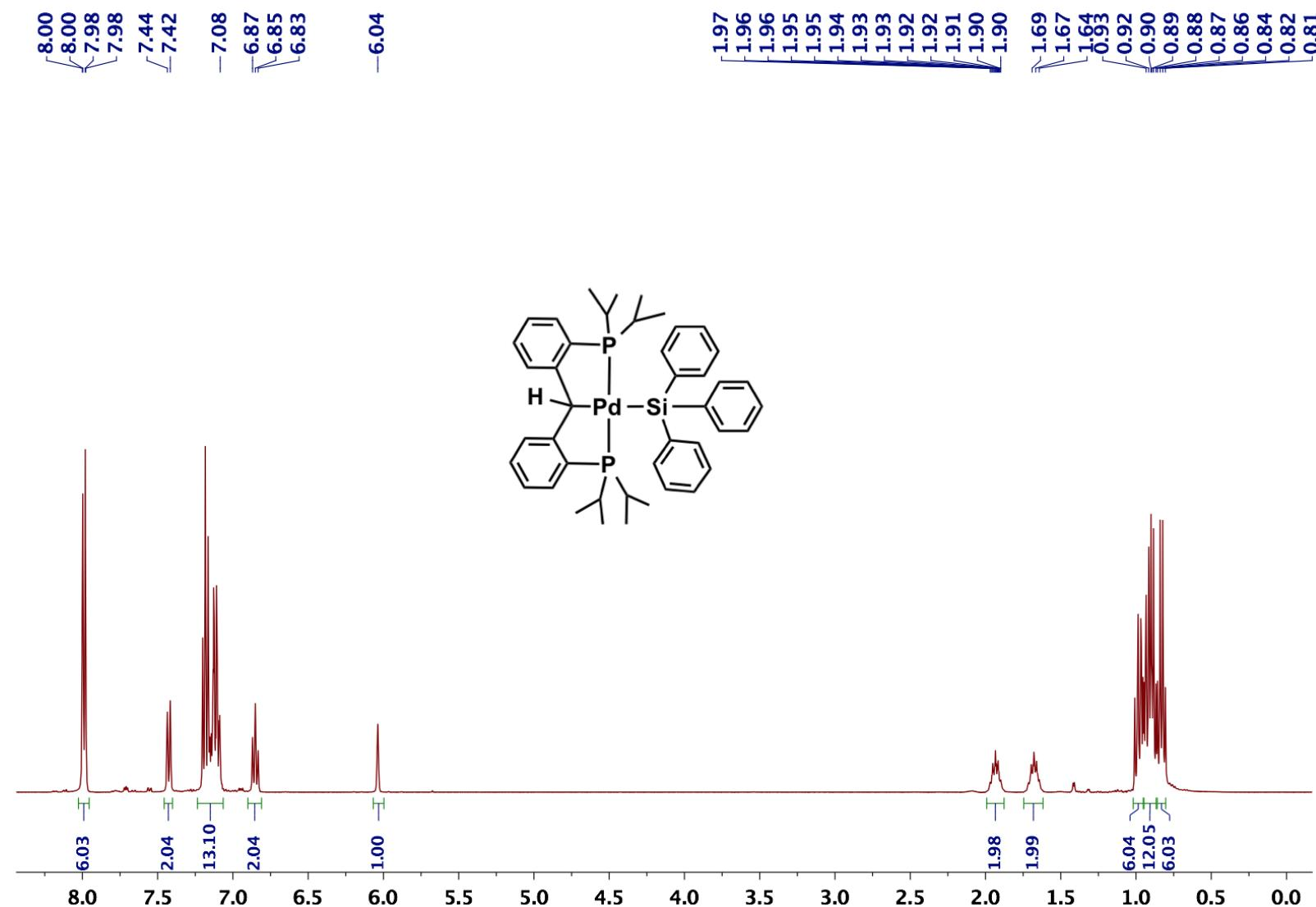
**Figure S26.** <sup>1</sup>H NMR spectrum for [PC(H)P]Pd(SiPh<sub>3</sub>) (8).
