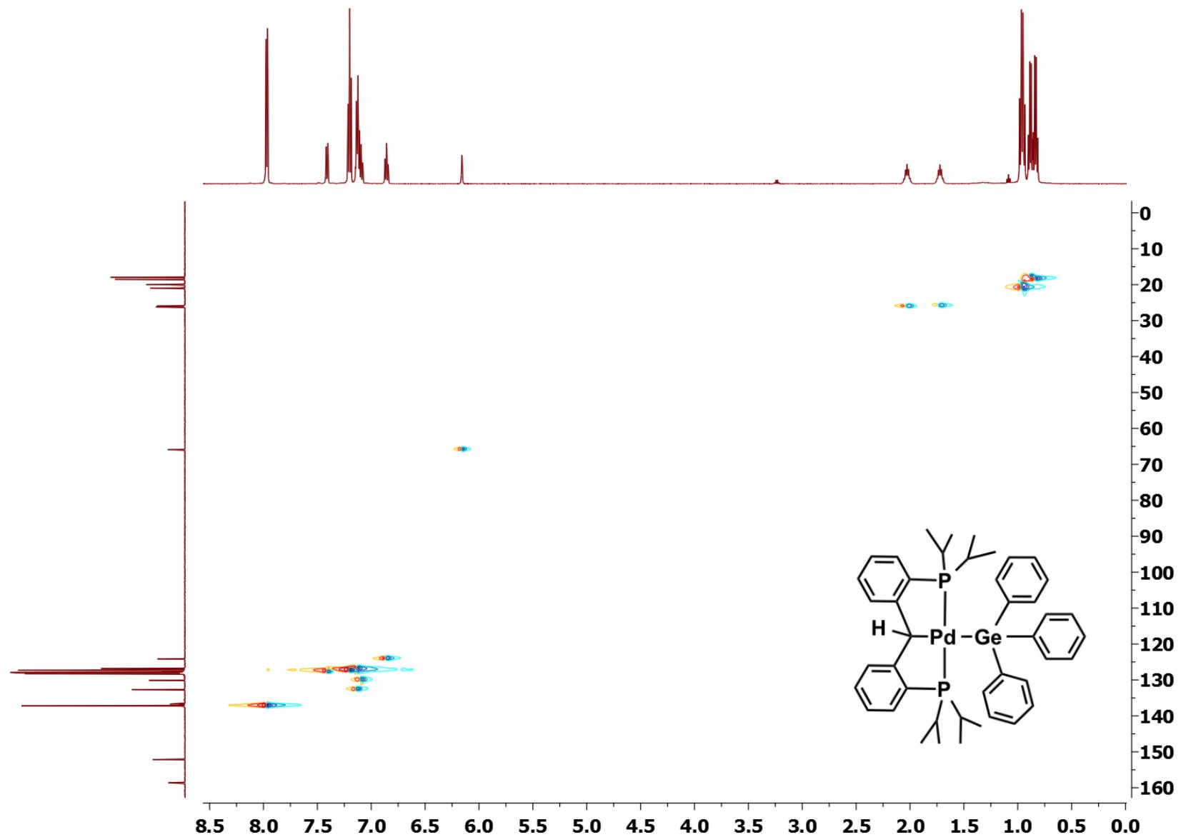
**Figure S50.**  $^1\text{H}$ - $^{13}\text{C}$  HSQC NMR spectrum for  $[PC(H)P]Pd(GePh_3)$  (12).
