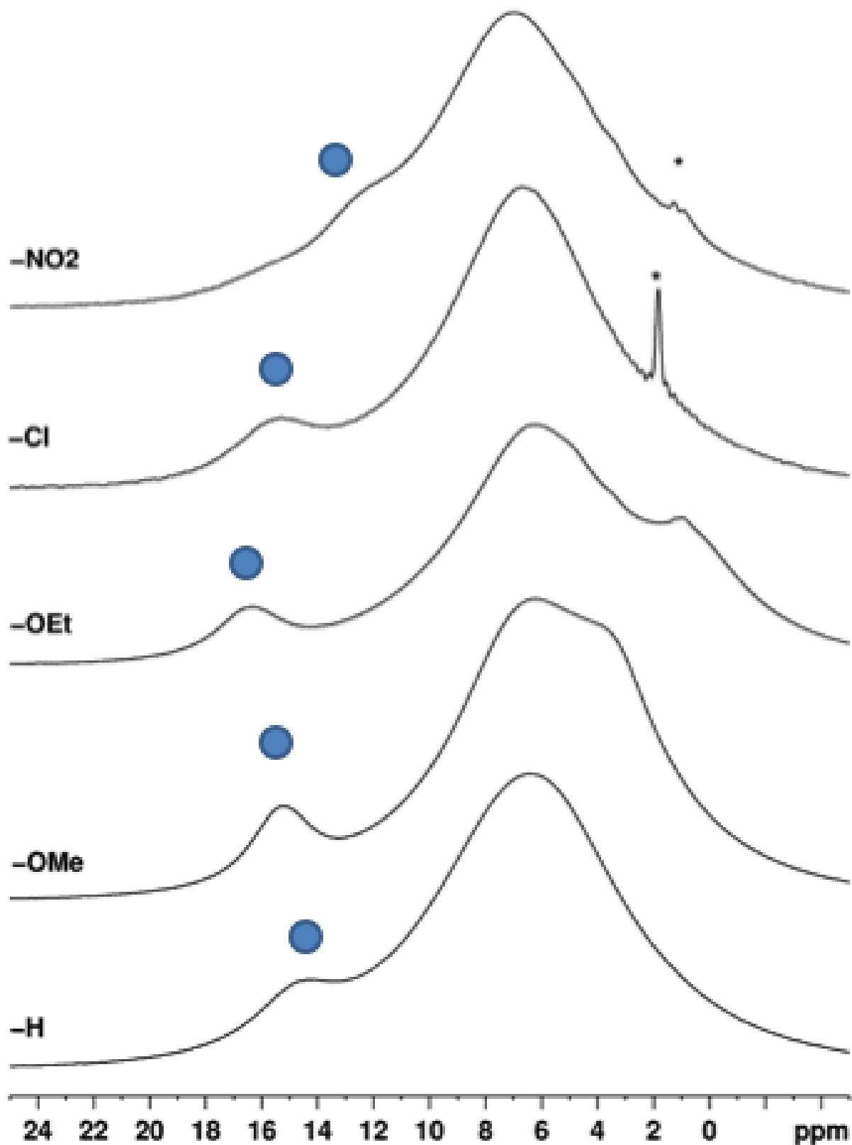
S4.2.  $^{13}\text{C}\{\text{H}\}$ CPMAS NMR spectrum of 3a-3e
