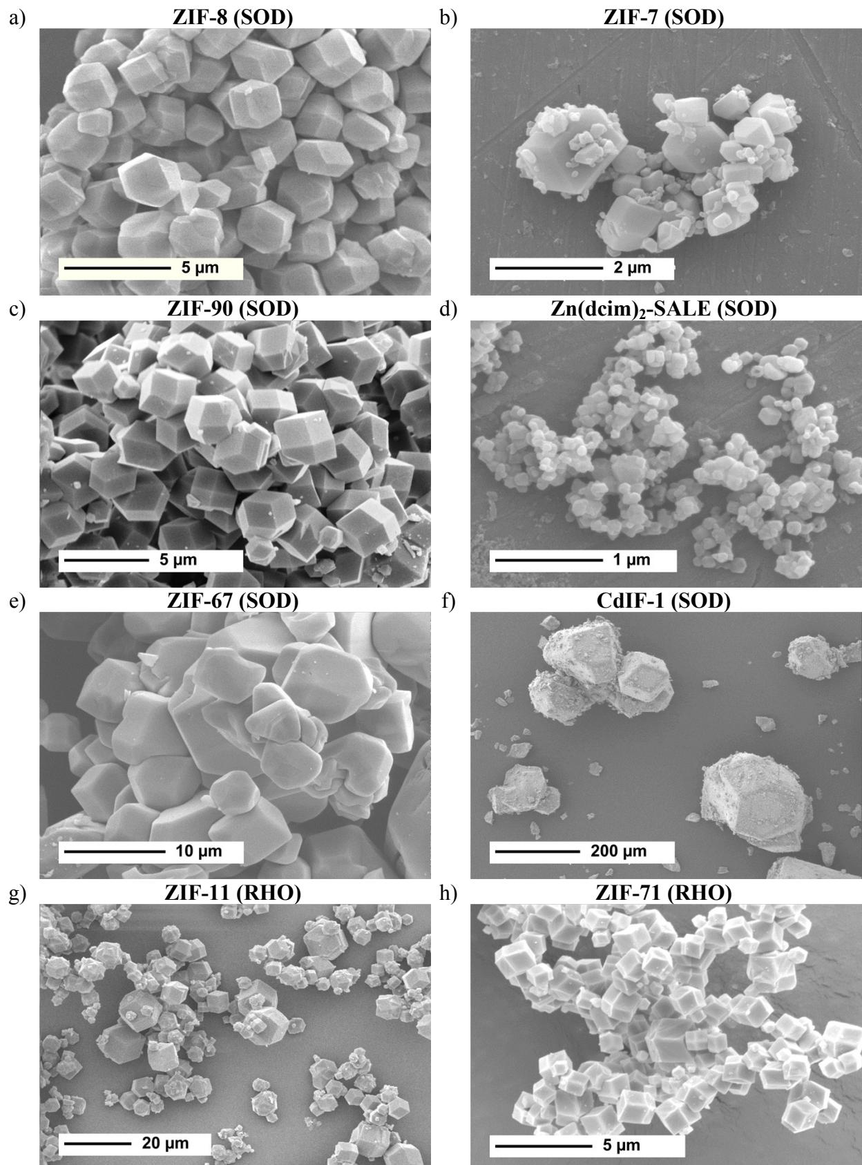
**Figure S3.** SEM micrographs of a) ZIF-8, b) ZIF-7, c) ZIF-90, d)  $\text{Zn}(\text{dcim})_2\text{-SALE}$ , e) ZIF-67, f) CdIF-1, g) ZIF-11 and h) ZIF-71 samples.
