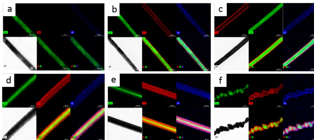
**Fig. S2** EDS element maps of Cu-Ni NWs with Cu/Ni molar ratio of (a) 3.5:1, (b) 2.1:1, (c) 1.6:1, (d) 1:1.4, (e) 1:2 and (f) 1:3.3.
