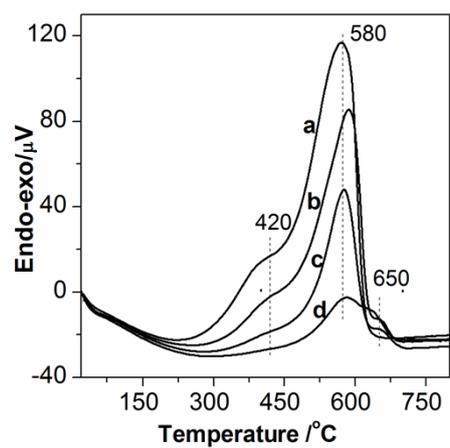
**Fig. S4** DTA profiles of the coked (a) H-MCM-22-15, (b) H-MCM-25-22, (c) H-MCM-22-37 and (d) H-MCM-22-50.
