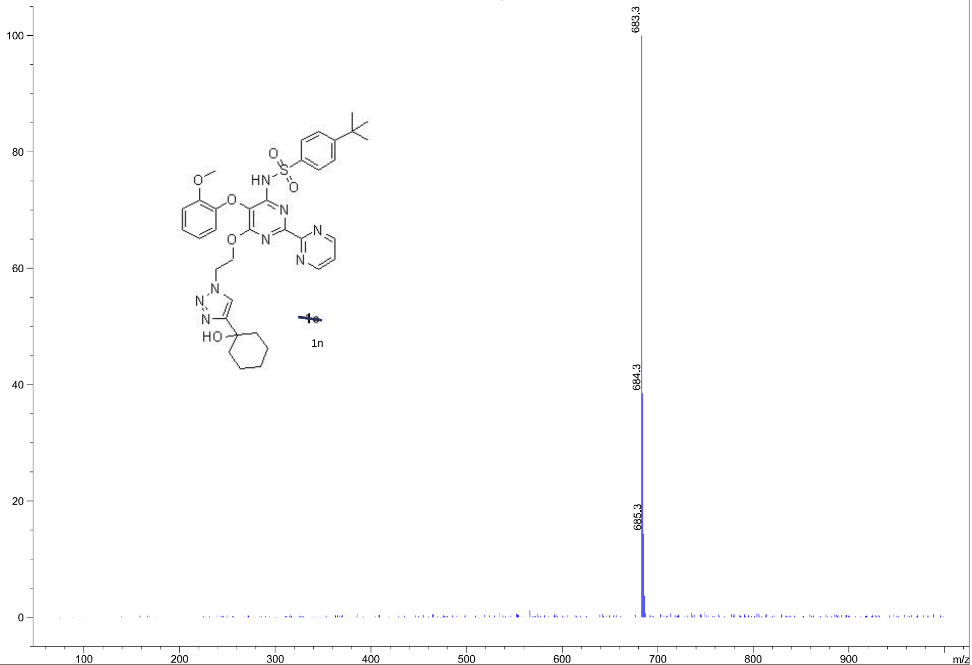
Figure 58: Mass NMR Spectrum of 4-tert-Butyl-N-(6-(2-(4-(1-hydroxycyclohexyl)-1H-1,2,3-triazol-1-yl)ethoxy)-5-(2-methoxyphenoxy)-2,2'-bipyrimidin-4-yl)benzenesulfonamide ( 1n )
