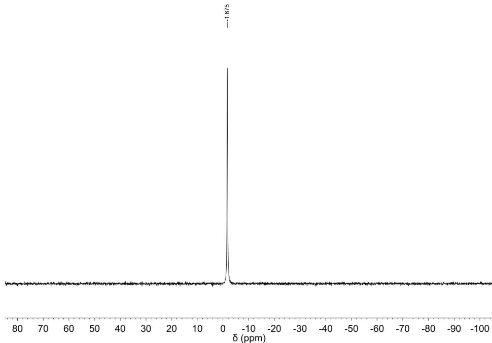
**Figure S8b.** <sup>7</sup>Li-NMR(155 MHz, THF-*d*<sub>8</sub>) of (RRR)-2-Ce-Cl(homo).
