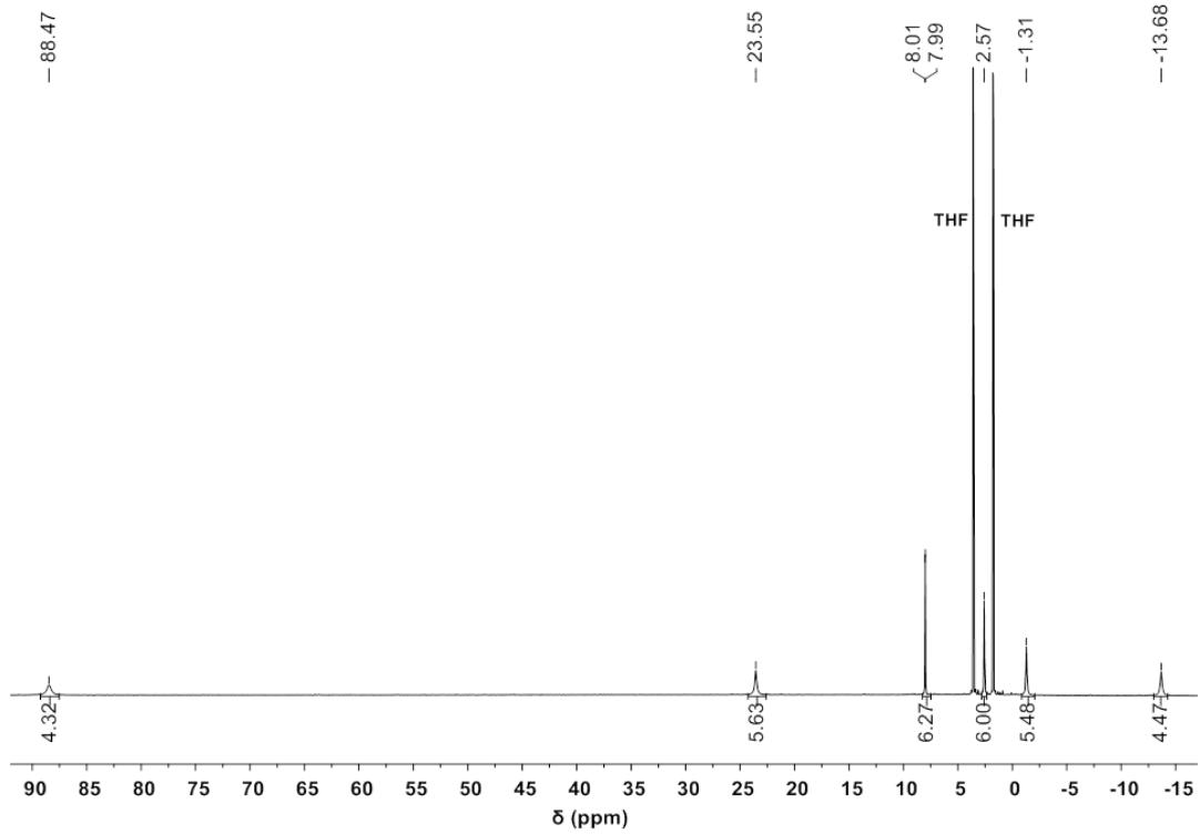
**Figure S2a.** <sup>1</sup>H-NMR(400 MHz, THF-*d*<sub>8</sub>) of **1-Yb(homo)**.
