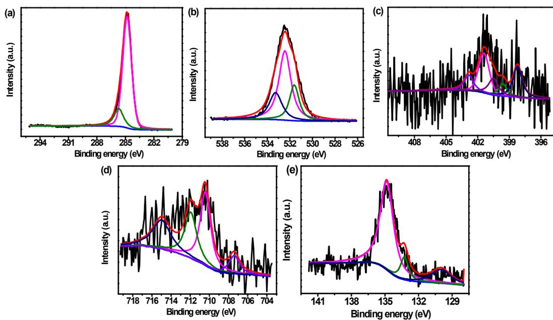
**Figure S3.** C1s (a), O1s (b), N1s (c), Fe2p (d) and P2p (e) core-level XPS spectra of SM-10.
