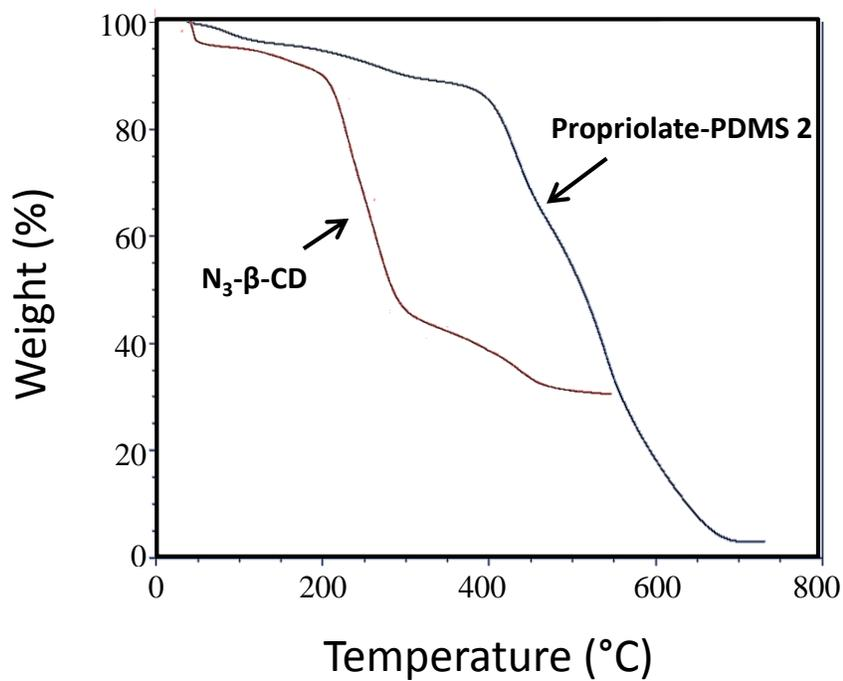
**Figure S4.** TGA of N<sub>3</sub>-β-CD 1 and propiolate-PDMS 2.
