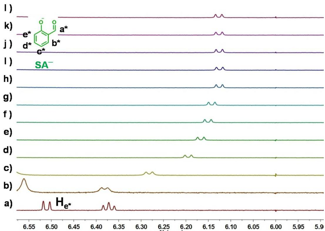
**Fig. S11** Partial  $^1\text{H}$  NMR spectra ( $\text{D}_2\text{O}$ , pH 11.0, 293 K, 400 MHz) of SA at a concentration of 1.00 mM with different concentrations of AP5: a) 0.000 mM, b) 0.310 mM, c) 0.550 mM, d) 0.810 mM, e) 1.01 mM, f) 1.40 mM, g) 1.60 mM, h) 3.22 mM, i) 4.22 mM, j) 4.90 mM, k) 6.02 mM, and l) 6.80 mM.
