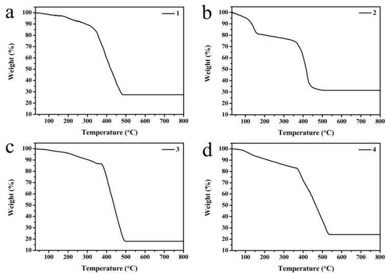
**Fig. S9.** Thermogravimetric analysis curves for (a) 1, (b) 2, (c) 3, (d) 4.
