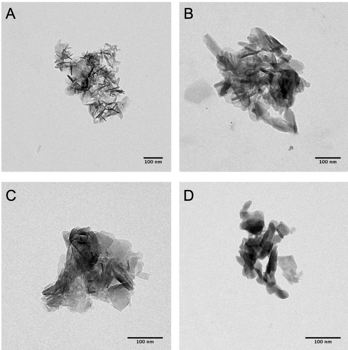
Fig. S3. TEM image of A) Mg<sub>4</sub>Al<sub>2</sub>, B) Mg<sub>2</sub>Cu<sub>2</sub>Al<sub>2</sub>, C) Mg<sub>2</sub>Co<sub>2</sub>Al<sub>2</sub>, D) Co<sub>2</sub>Cu<sub>2</sub>Al<sub>2</sub>
