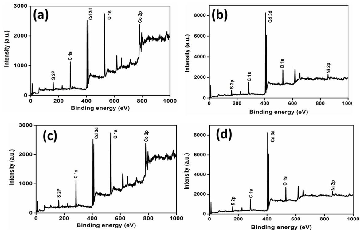
**Figure SI 3** (a) XPS survey spectra of (a)  $\text{Co(OH)}_2$ , (b)  $\text{Ni(OH)}_2$ , (c)  $\text{Co}_3\text{O}_4$  and (d)  $\text{NiO}$  modified CdS films.
