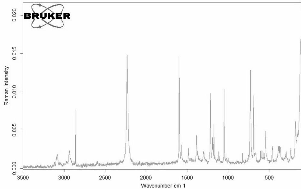
Figure S22. Raman spectrum of  $[o\text{-CH}_3\text{C}_6\text{H}_4\text{CNH}]\text{[AsF}_6\text{]}$ .
