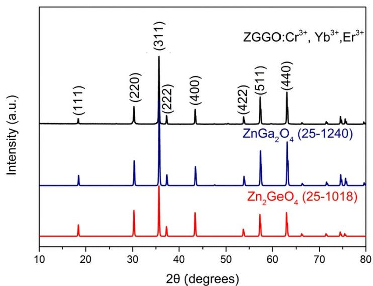
**Fig. S6** The XRD patterns of ZGGO:Cr<sup>3+</sup>, Yb<sup>3+</sup>, Er<sup>3+</sup> powder.
