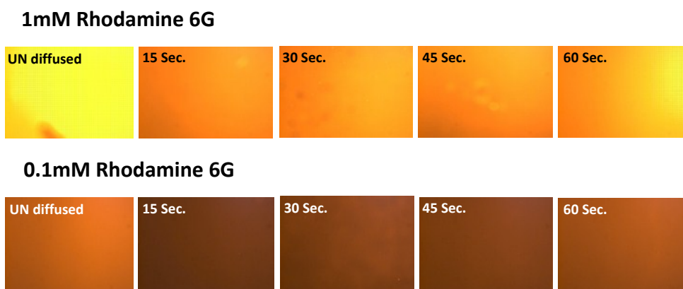
Fig. 2 Rhodamine 6G releasing rate.
