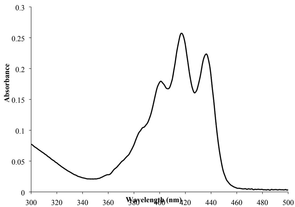
**Figure S3.** UV-vis absorption spectrum of 2.8 mM **2** in  $\text{CH}_3\text{OH}$ .
