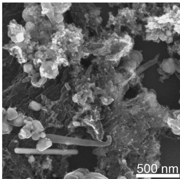
**Fig. S4** SEM image of Fe<sub>3</sub>C@N-C.
