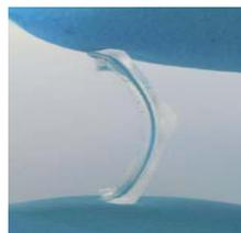
**Fig. S1** Photography of a TMOS-DMDMS ionogel flexible membrane.
