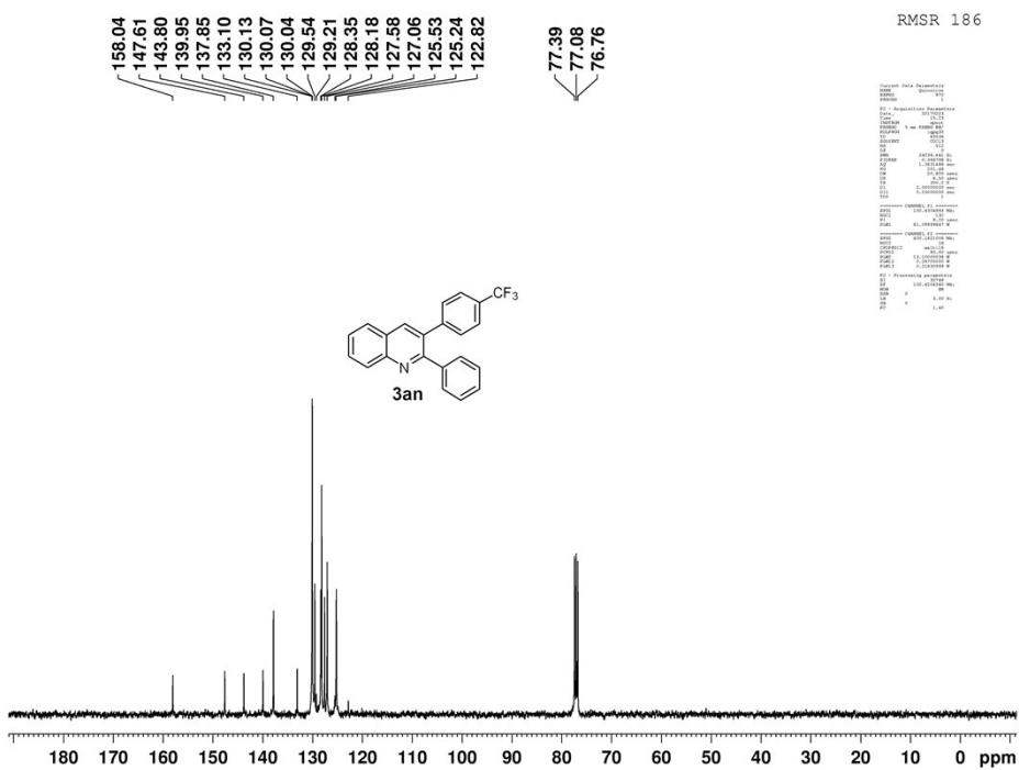
Fig. S28  $^{13}\text{C}$  NMR of **3an**
