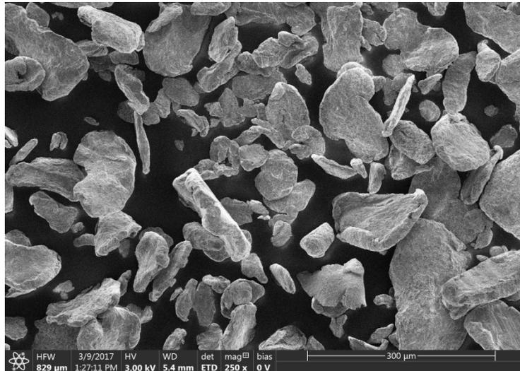
Figure 1. SEM of Mg (Grüssing GmbH, 99%).
