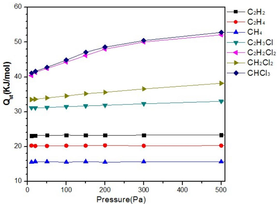
Fig.S3 Isosteric heats of  $C_2H_2$ ,  $C_2H_4$ ,  $CH_4$ ,  $C_2H_3Cl$ ,  $C_2H_2Cl_2$ ,  $CH_2Cl_2$  and  $CHCl_3$  adsorbed in CPM-200-In/Mg at 298 K
