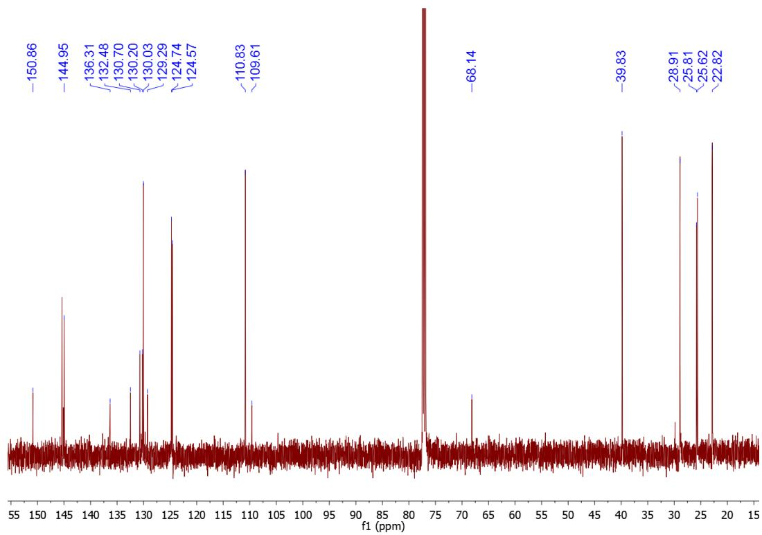
**Plot P55.**  $^{13}\text{C}\{\text{H}\}$  NMR spectrum of  $\{\text{aIPr}(4\text{-Me}_2\text{N-C}_6\text{H}_4)\text{CuBr}$  (**23**).
