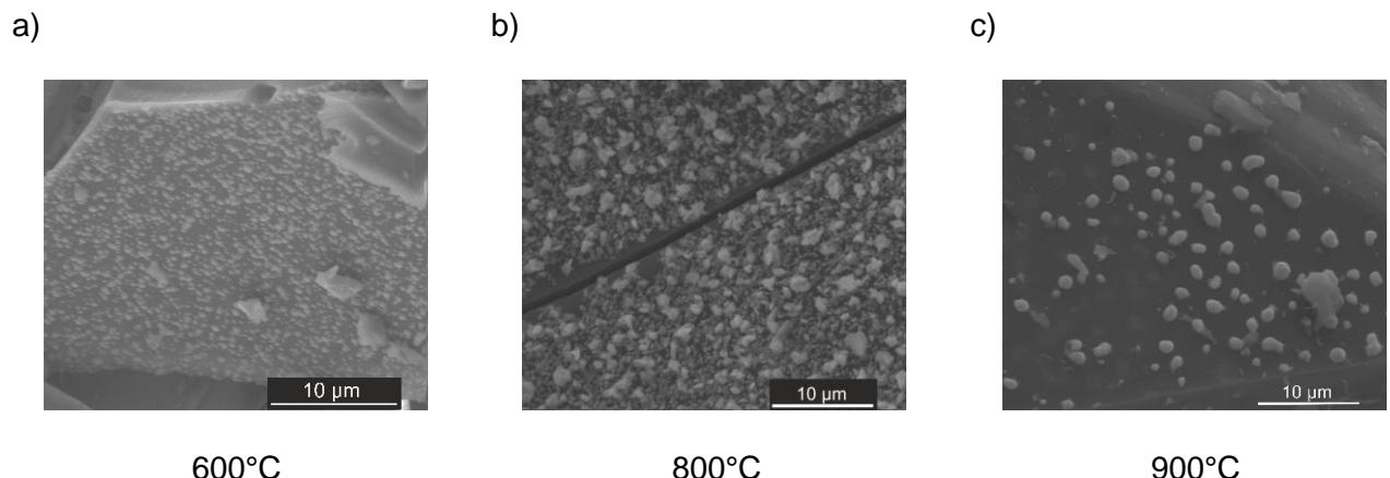
**Figure S 12** SEM pictures with 10 µm scale bar for materials a) C4\_600, b) C4\_800 and c) C4\_900.
