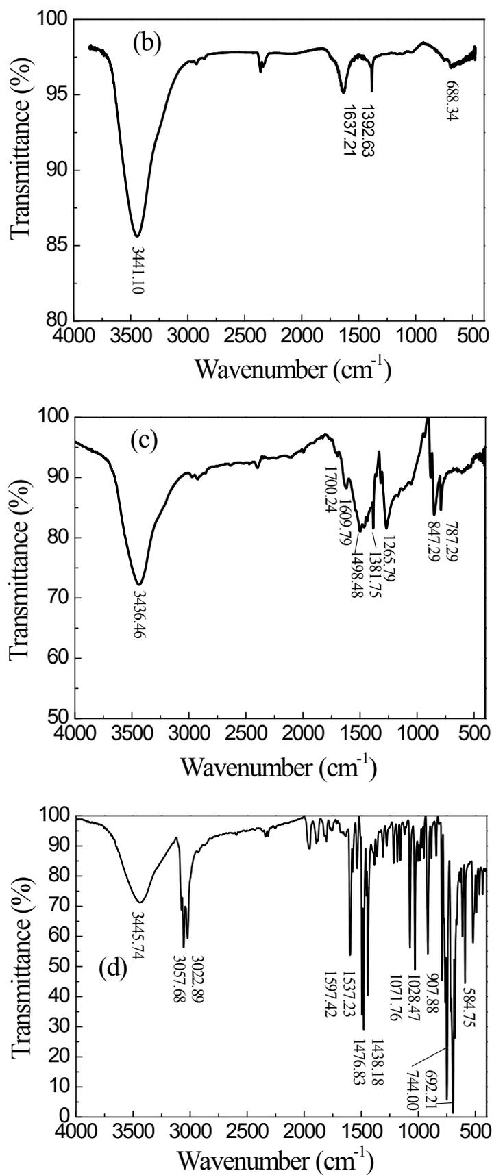
Fig. S1. FT-IR spectra of the (a) TTPT, (b) I<sub>2</sub>@TPTT, (c) TCT, and (d) TPT.
