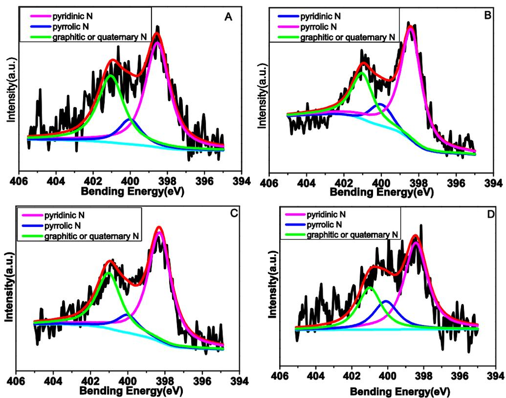
Figure S26. N 1s XPS spectrum of  $EZ_X-C$ , A)  $EZ_{0.5}-C$ , B)  $EZ_1-C$ , C)  $EZ_{1.5}-C$  and D)  $EZ_2-C$ .
