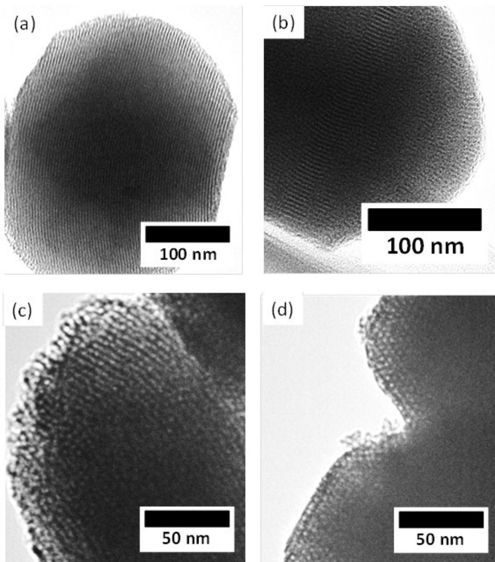
**Fig. S2** TEM images of the (a) Eu:MPS, (b) MC1-Eu:MPS, (c) MC2-Eu:MPS and (d) MC3-Eu:MPS particles.
