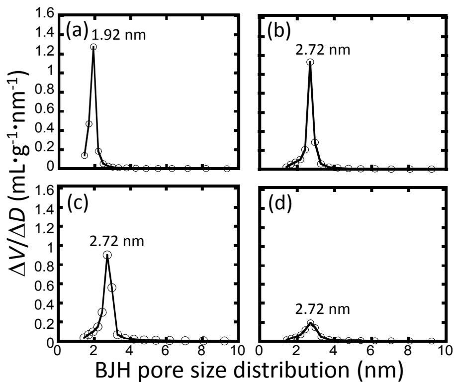
**Fig. S3** BJH pore size distributions of the (a) Eu:MPS, (b) MC1-Eu:MPS, (c) MC2-Eu:MPS and (d) MC3-Eu:MPS particles.
