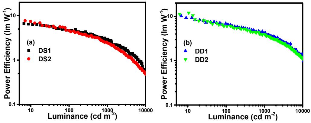
**Fig. S2.** Power efficiency-luminance ( $\eta_p$ - $L$ ) curves of devices (a) DS1 and DS2, (b) DD1 and DD2.
