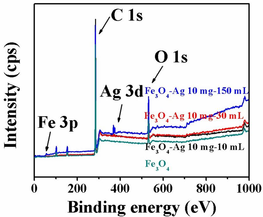
Fig. S6 XPS survey scan spectra of pure  $\text{Fe}_3\text{O}_4$ ,  $\text{Fe}_3\text{O}_4$ -Ag 10 mg-10 mL,  $\text{Fe}_3\text{O}_4$ -Ag 10 mg-30 mL and  $\text{Fe}_3\text{O}_4$ -Ag 10 mg-150 mL.
