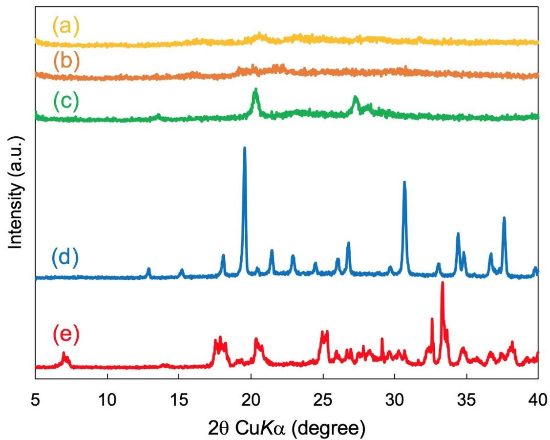
**Fig. S2.** XRD patterns of (a) cPEI/*m*-TA (b) cPEI/MA, (c) cPEI, (d) MA, (e) *m*-TA.
