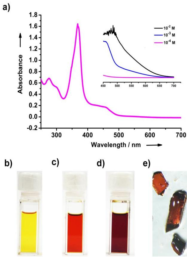
**Figure S77** The absorption spectrum of  $[4a^{\bullet+}] \bullet [B(C_6F_5)_4]^-$  (a). Pictures of  $\text{CH}_2\text{Cl}_2$  solutions of  $[4a^{\bullet+}] \bullet [B(C_6F_5)_4]^-$   $[1 \times 10^{-4} \text{ M}$  (b)  $1 \times 10^{-3} \text{ M}$  (c),  $1 \times 10^{-2} \text{ M}$  (d). Crystals of  $[4a^{\bullet+}] \bullet [B(C_6F_5)_4]^-$  (e).
