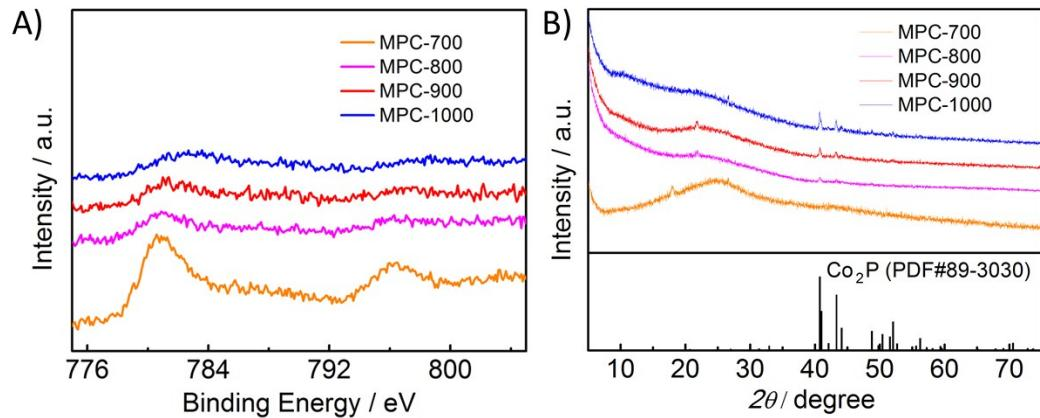
**Fig. S16** A) Co 2p XPS and B) XRD spectra of MPCs.
