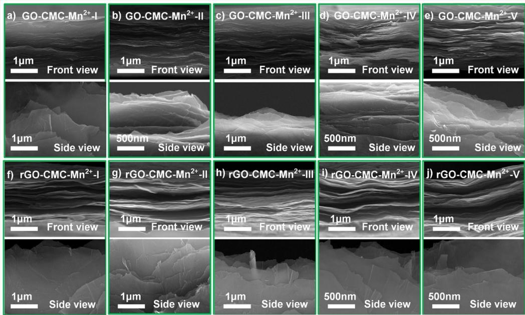
**Figure S6.** The front and side view fracture morphologies of GO-CMC-Mn<sup>2+</sup> nanocomposites with different concentrations of Mn<sup>2+</sup>. a) GO-CMC-Mn<sup>2+</sup>-I, b) GO-CMC-Mn<sup>2+</sup>-II, c) GO-CMC-Mn<sup>2+</sup>-III, d) GO-CMC-Mn<sup>2+</sup>-IV, e) GO-CMC-Mn<sup>2+</sup>-V, f) rGO-CMC-Mn<sup>2+</sup>-I, g) rGO-CMC-Mn<sup>2+</sup>-II, h) rGO-CMC-Mn<sup>2+</sup>-III, i) rGO-CMC-Mn<sup>2+</sup>-IV, and j) rGO-CMC-Mn<sup>2+</sup>-V nanocomposites, respectively.
