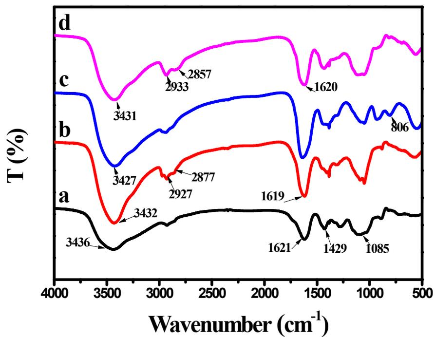
**Fig. S2.** FT-IR spectra of (a) 0.7-HS-SA, (b) 0.7-HS-PDA@PEI-SA@PEI, (c) 0.7-HS-PDA@PEI-SA@PEI-Cr and (d) F-SA.
