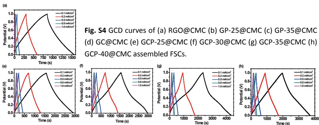
**Fig. S4** GCD curves of (a) RGO@CMC (b) GP-25@CMC (c) GP-35@CMC (d) GC@CMC (e) GCP-25@CMC (f) GCP-30@CMC (g) GCP-35@CMC (h) GCP-40@CMC assembled FSCs.
