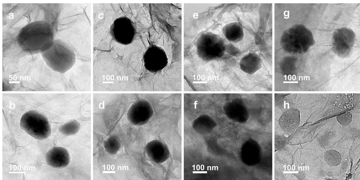
**Figure S9.** TEM pictures of 3DG/FeS@C after different discharge/charge cycles: (a) 1<sup>st</sup> discharge, (b) 1<sup>st</sup> charge, (c) 10<sup>th</sup> discharge, (d) 10<sup>th</sup> charge, (e) 40<sup>th</sup> discharge, (f) 40<sup>th</sup> charge, (g) 80<sup>th</sup> discharge, (h) 80<sup>th</sup> charge.
