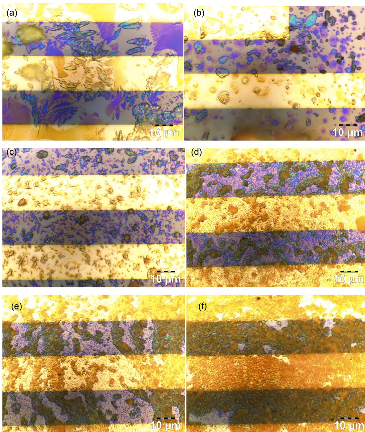
**Fig. S7.** Optical microscope images of devices whose active layer is a DH4T/DH6T blend in chloroform. Films consist of (a) pure DH4T; (b) 90 wt% of DH4T; (c) 50 wt% of DH4T; (d) 10 wt% of DH4T; (e) 2 wt% of DH4T and (f) pure DH6T [W= 10 mm, L = 20  $\mu$ m].
