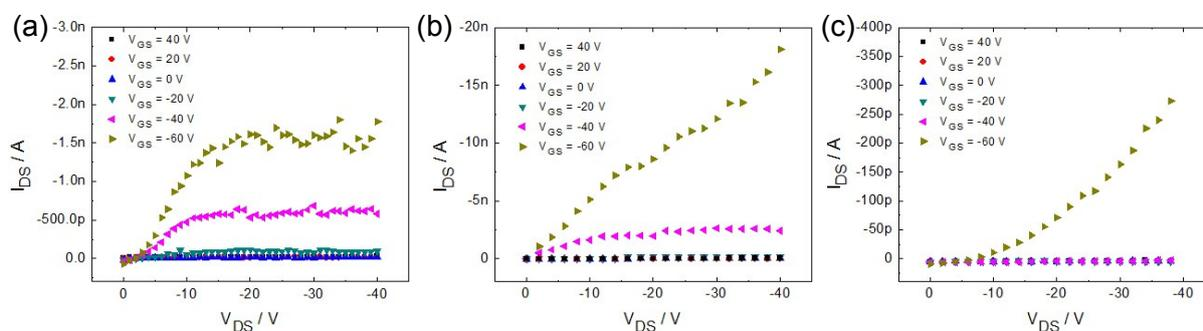
**Fig. S3.** Output curves of  $L = 20 \mu\text{m}$  transistors of blends of DH4T and DH2T in chloroform. Films consist of (a) pure DH4T; (b) 99 wt% of DH4T; (c) 95 wt% of DH4T.
