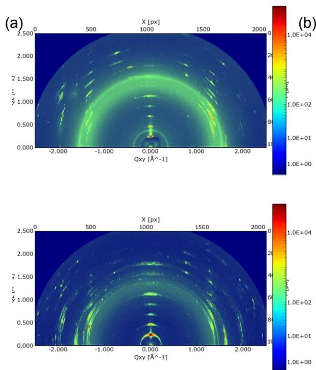
**Fig. S1.** 2D GIXD patterns of films drop-cast on bare Si. (a) Pure DH4T dropcasted from dichlorobenzene ; (b) DH2T/DH4T blend containing 2% DH2T and 98% DH4T.
