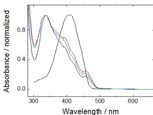
**Fig. S2.** Normalized absorbance spectra of DH4T dissolved in DCB (black), and of dropcasted films containing pristine DH4T (red), 1% DH2T in DH4T (blue), and 5% DH2T in DH4T (green).
