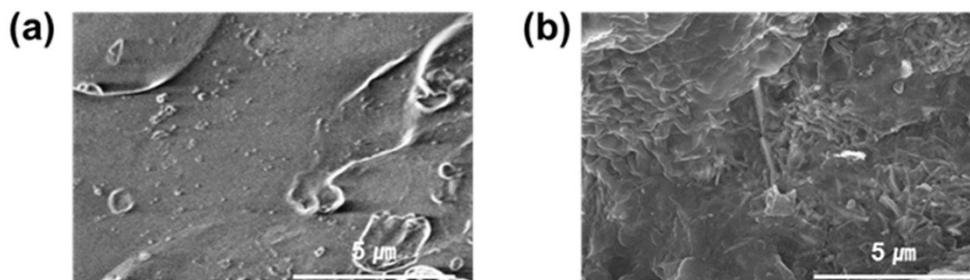
Fig. S6 Microstructures of (a) GA/PDMS and (b) AgNW/GA/PDMS nanocomposites
