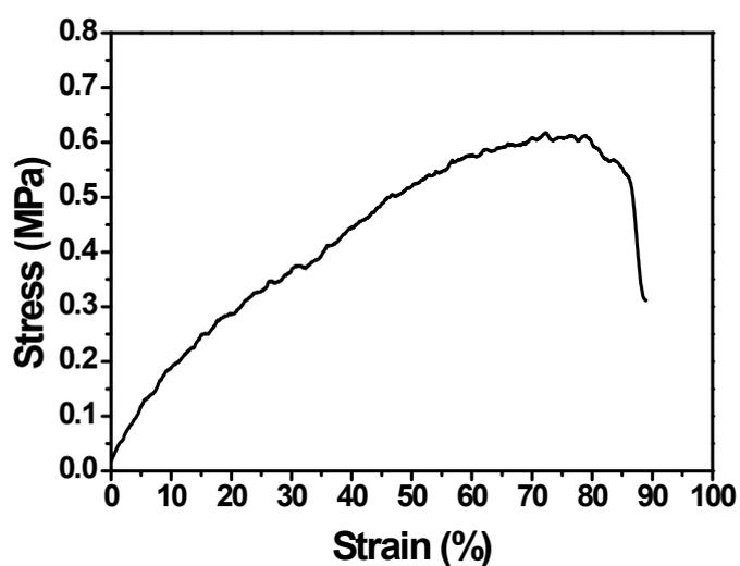
Fig. S5 Strain-Stress curve of AgNW(0.7 vol.)/GA/PDMS nanocomposites
